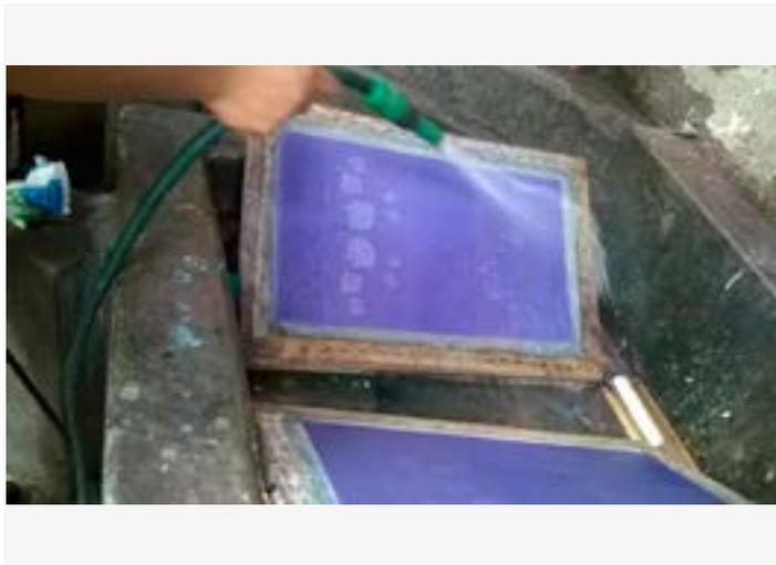
Figura 235: Proceso de lavado del bastidor.
