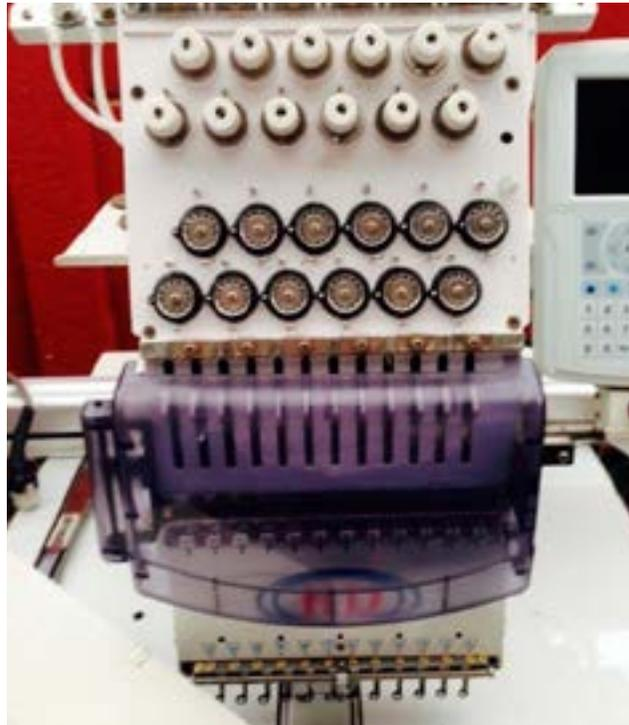
Figura 6: Cabezal de bordadora.
