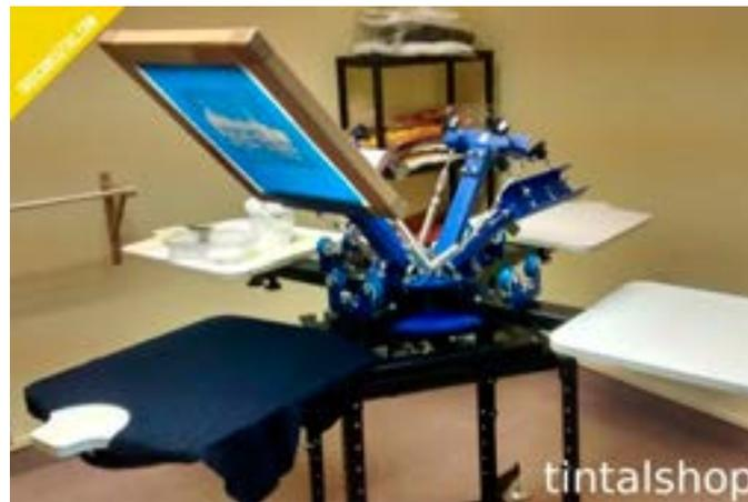
Figura 36: Bastidor colocado en el pulpo.
