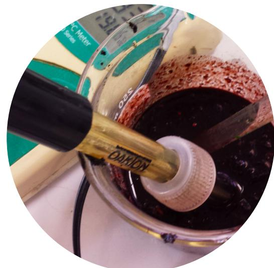
Figura 82: Obtención de pH (Espuela)
