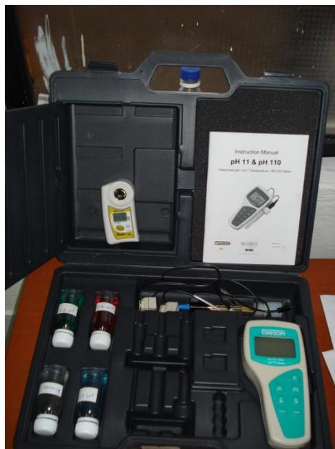
Figura N°74. Potenciómetro y brixómetro digital. Control de calidad. Julio 2010.
