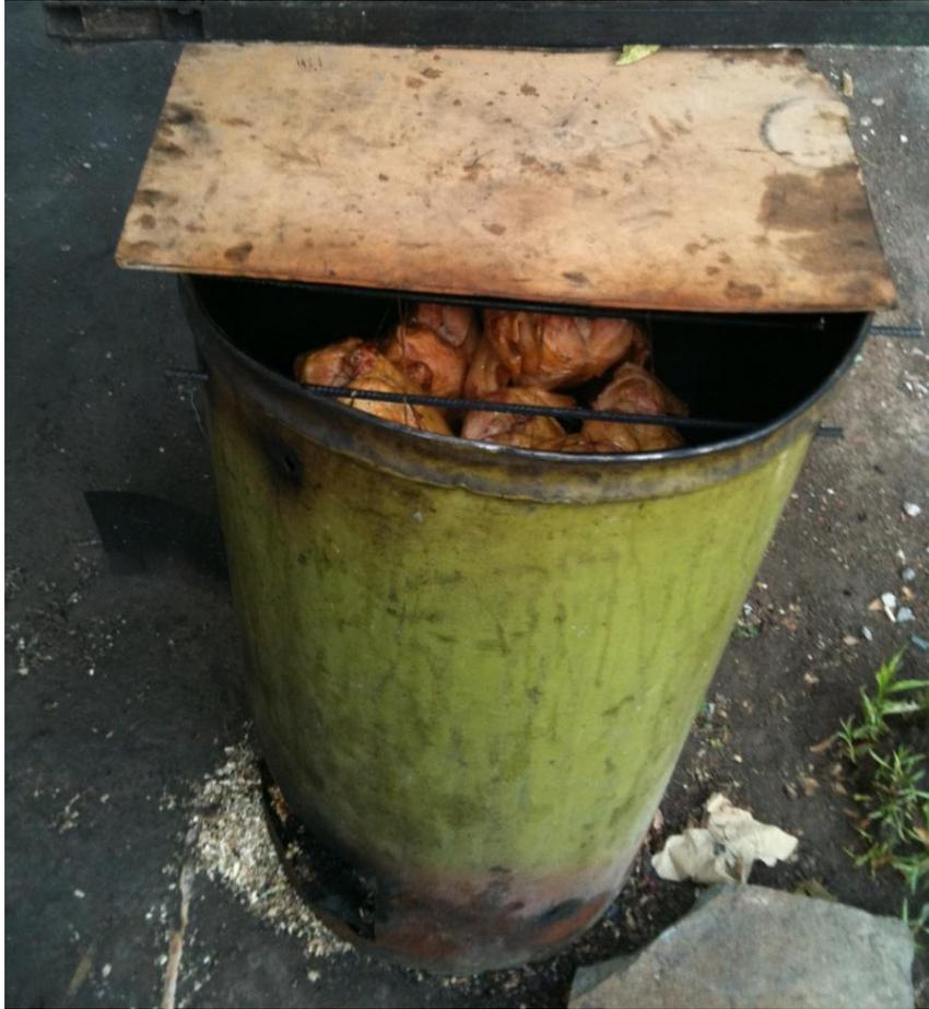
Figura N°38. Tanque de ahumado artesanal con aplicación directa de humo de la combustión de carbón y viruta .Junio de 2010.
