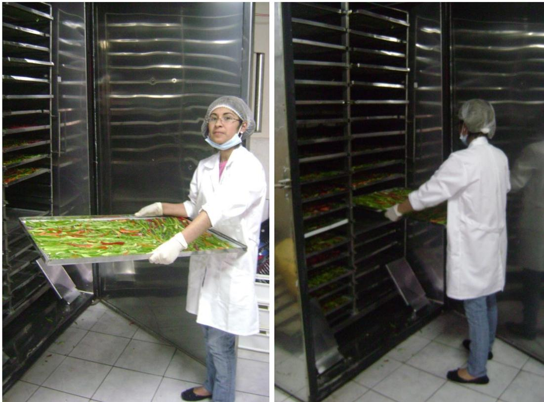
Figura N°34, 35. Equipo deshidratador. Bandejas con malla en acero inoxidable. Abril de 2010.
