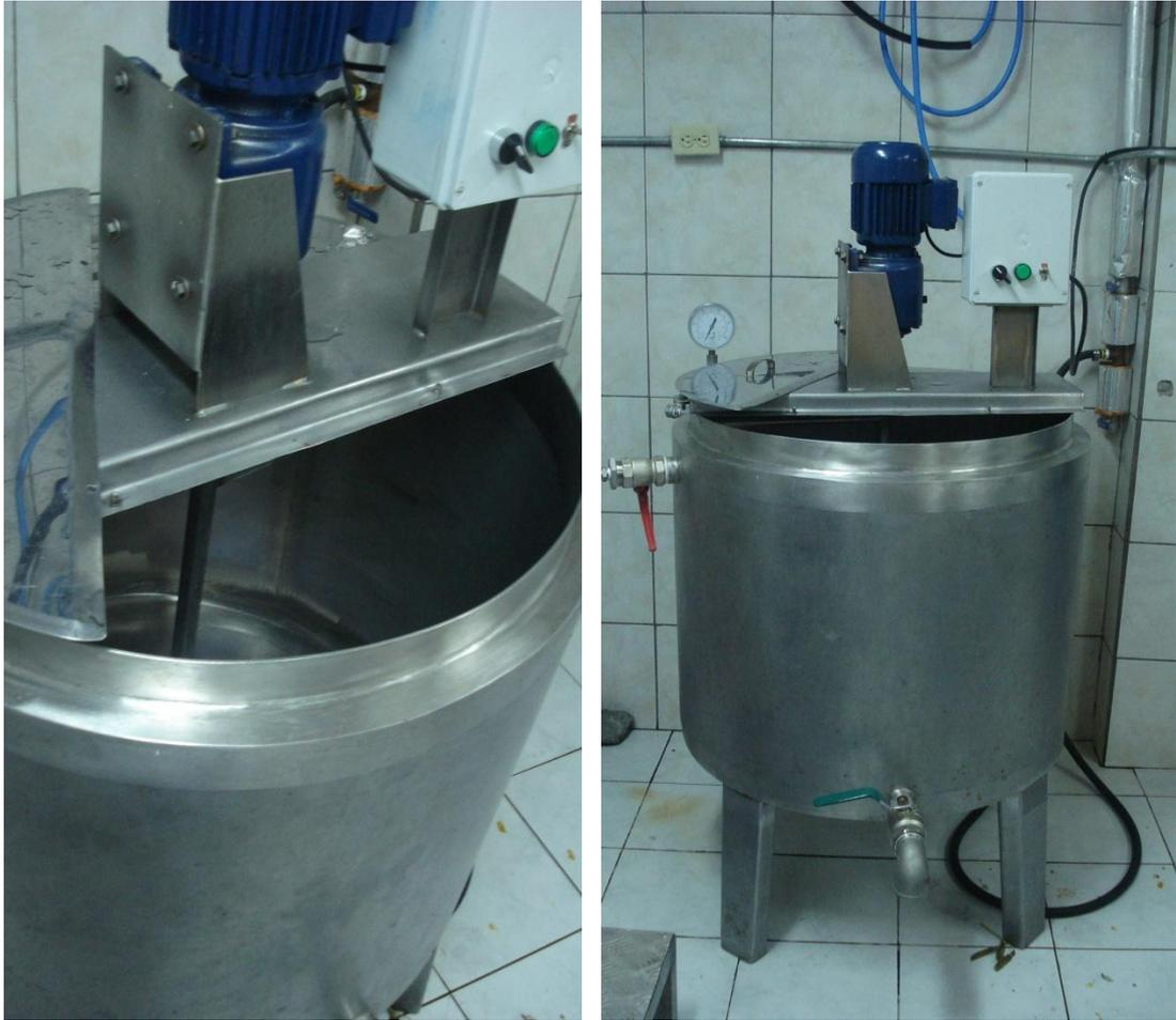
Figura N°32, 33. Marmita fondo plano, 250 litros con agitador. Sin utilización por falta de generación de vapor. Abril de 2010.
