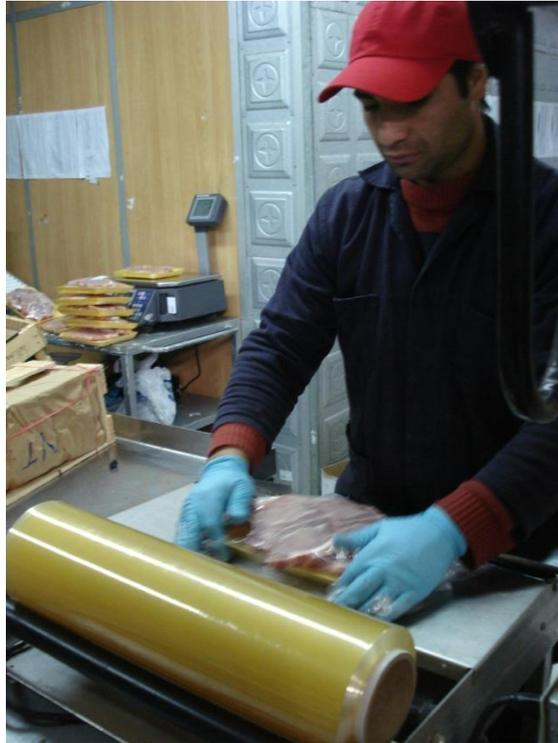
Figura N°61. Empacado manual de bandeja termo formada. Febrero, 2011.
