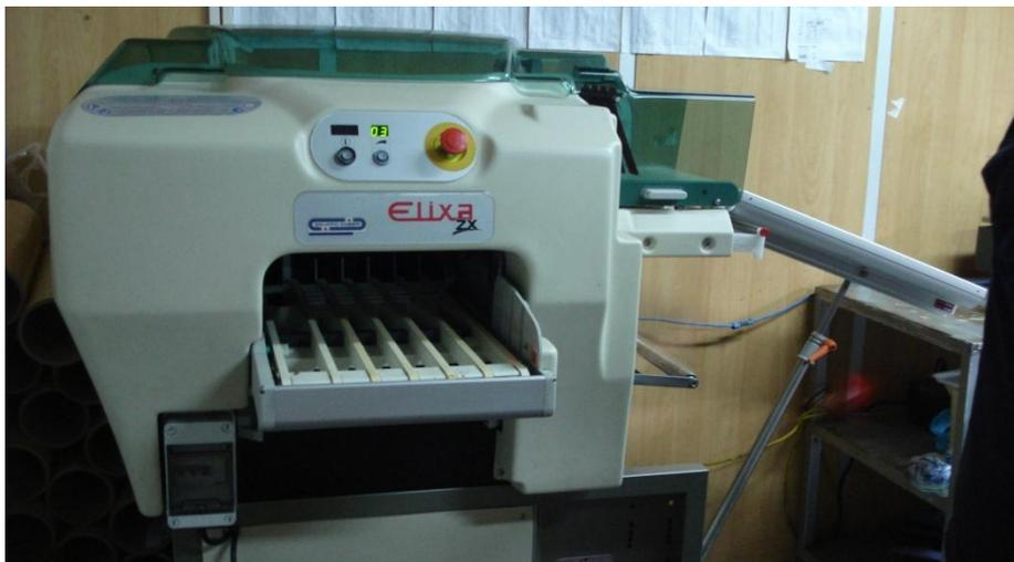
Figura N°62. Empacadora automática de bandeja termo formada. Marzo, 2011.
