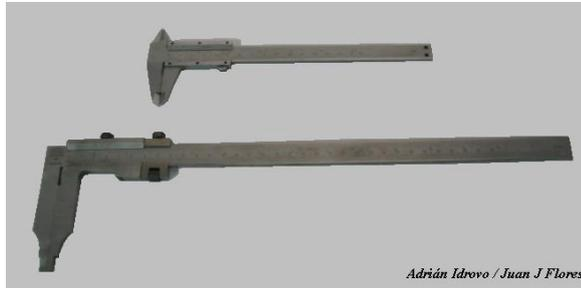
**b.) Calibrador micrómetro.-** Utilizado para verificar tolerancias.
