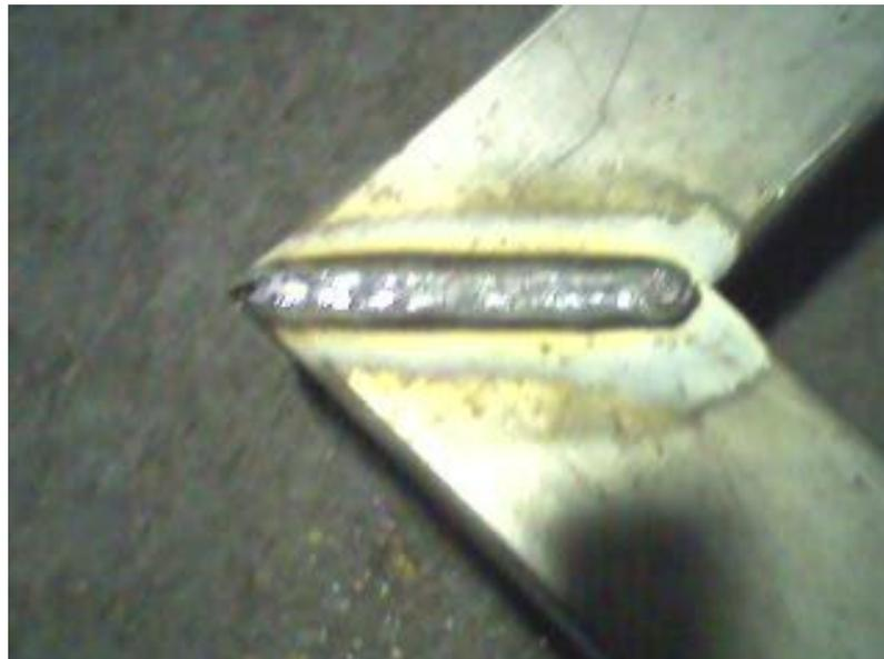
Figura 2-80: Realización del cordón de Soldadura
