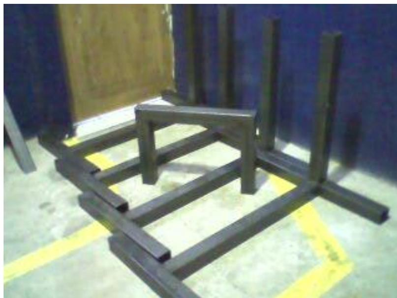
Figura 2-78: Estructuras soldadas solo con puntos.
