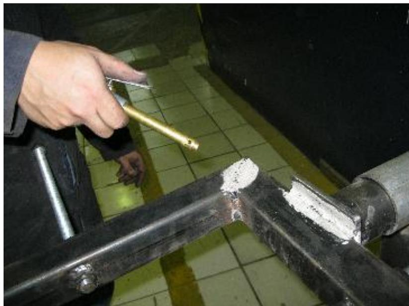
Figura 2-100: Limpieza con aire a presión
