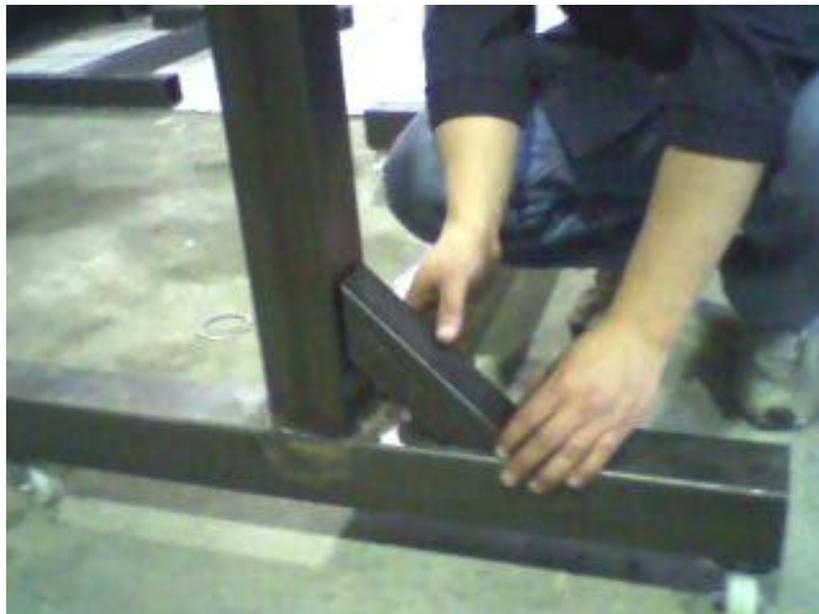
Figura 2-88: Colocación de los nervios en las estructuras
