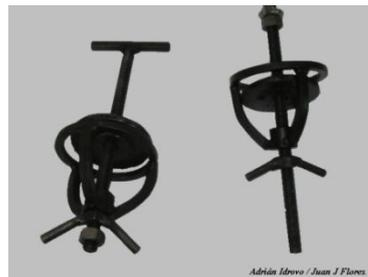
**k.) Prensa.-** Utilizado para colocar y sacar rodillos.
