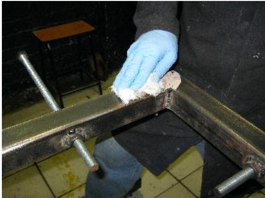
Figura 2-101: Limpieza con disolvente
