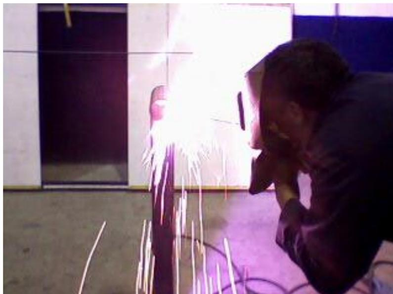
Figura 2-84: Soldado de los tubos que van a los sujetadores
