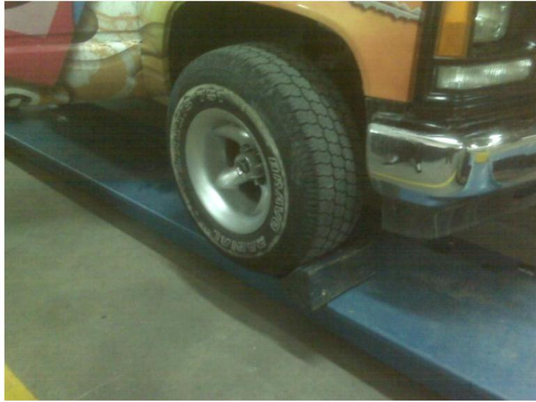
Figura 3-18: Lastrado del vehículos para las pruebas de diagnostico
