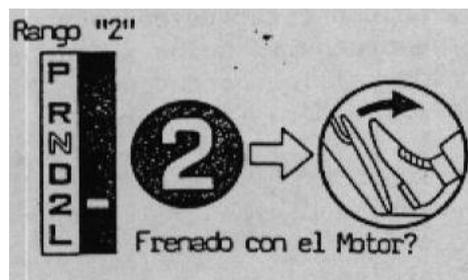
Figura 2-65: Compruebe que el efecto de frenado con el motor toma lugar
