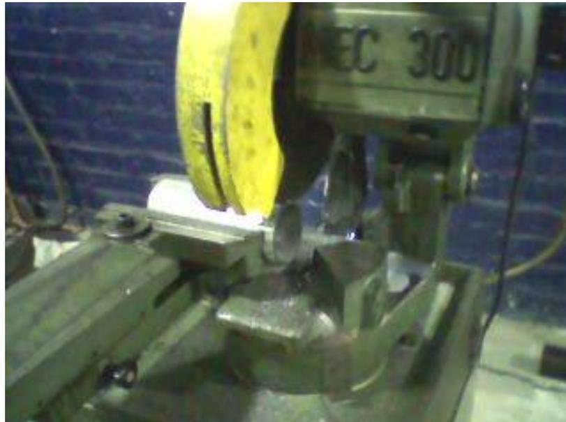
Figura 2-83: Cortes de los tubos que van a los sujetadores
