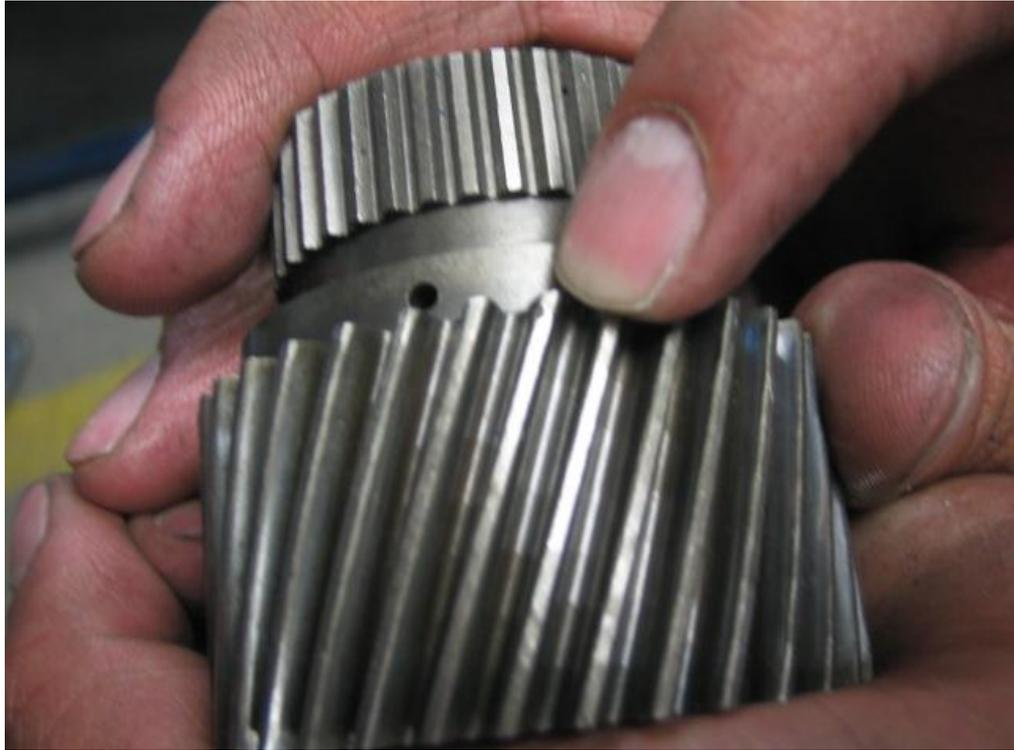
Figura 3-26: Verificación del Piñón Planetario del Tren Epicicloidal
