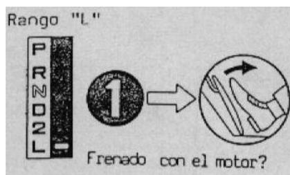
Figura 2-68: Verificación del efecto de frenado con el motor
