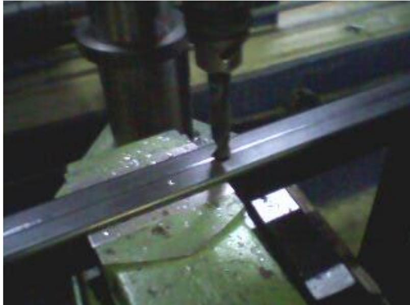
Figura 2-91: Realización de los orificios
