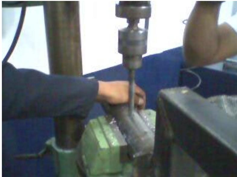
Figura 2-93: Realización de los orificios
