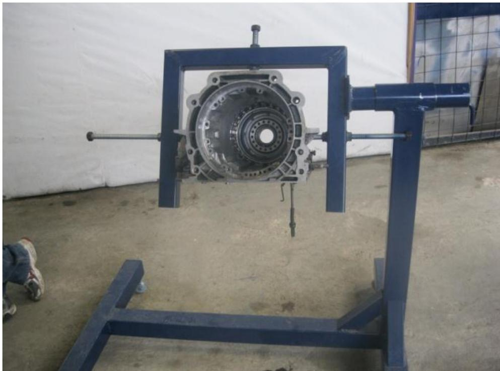
Figura 3-33: Fijación de la carcasa de la transmisión para su armado
