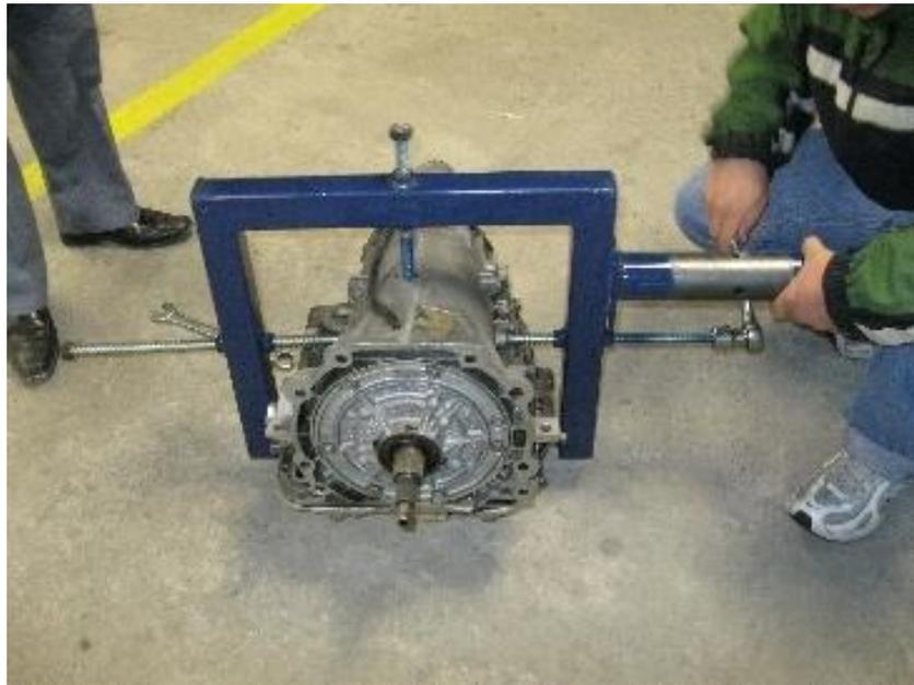
Figura 2-105: Sujeción de la Transmisión automática
