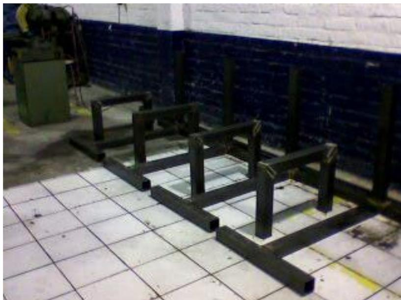
Figura 2-82: Estructuras Soldadas
