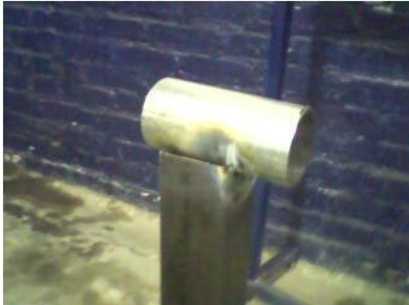
Figura 2-85: Puntos de sujeción de suelda
