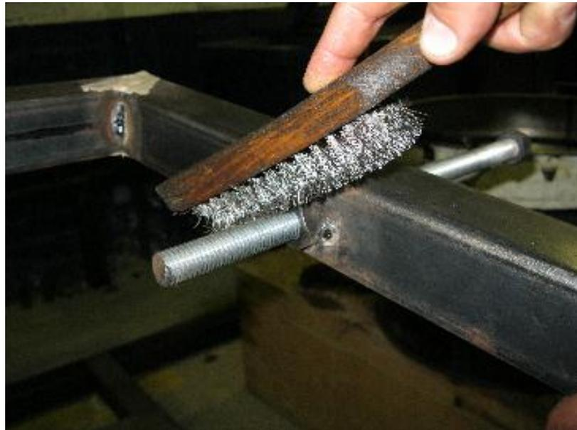
Figura 2-97: Limpieza de la escoria de soldadura
