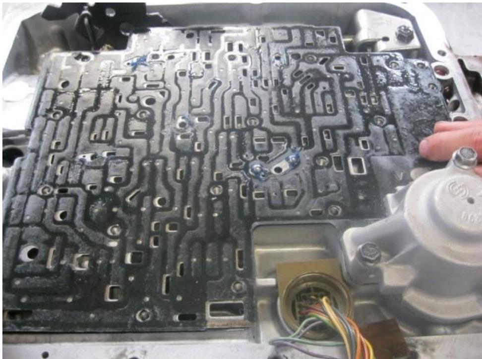
Figura 3-31: Verificaciones en el Cuerpo de Válvulas
