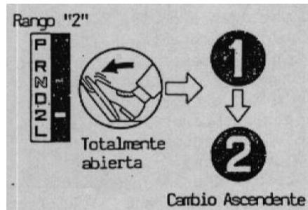
Figura 2-64: Prueba en el Rango "2"
