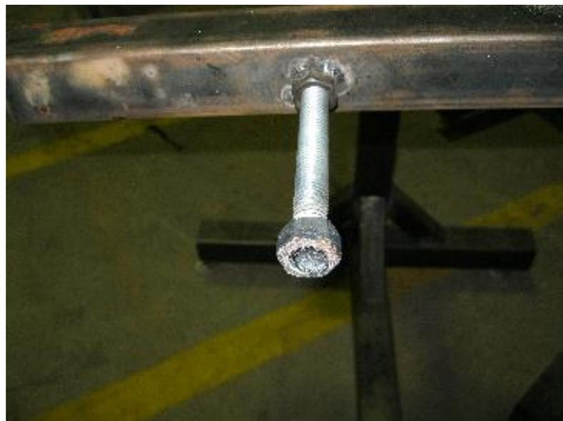
Figura 2-94: Pernos de sujeción en los soportes
