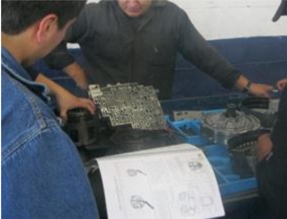
Figura 3-34: Armado del cuerpo de válvulas
