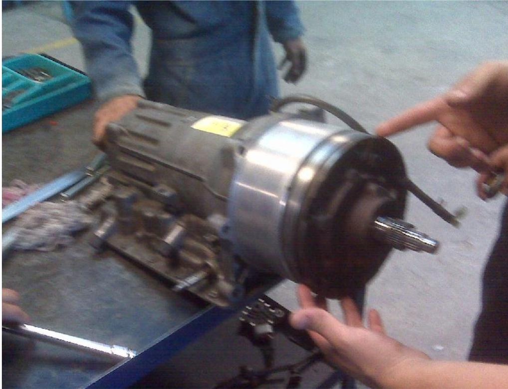
Figura 3-24 Desmontaje de la bomba de aceite de Transmisión Automática 65J-10
