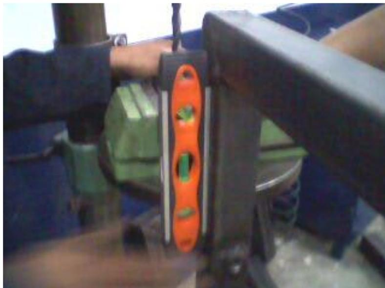
Figura 2-92: Nivelación del soporte de sujeción
