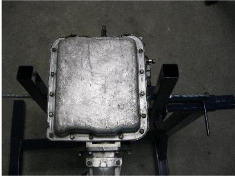
Figura 2-109: Vista inferior de la Transmisión Automática
