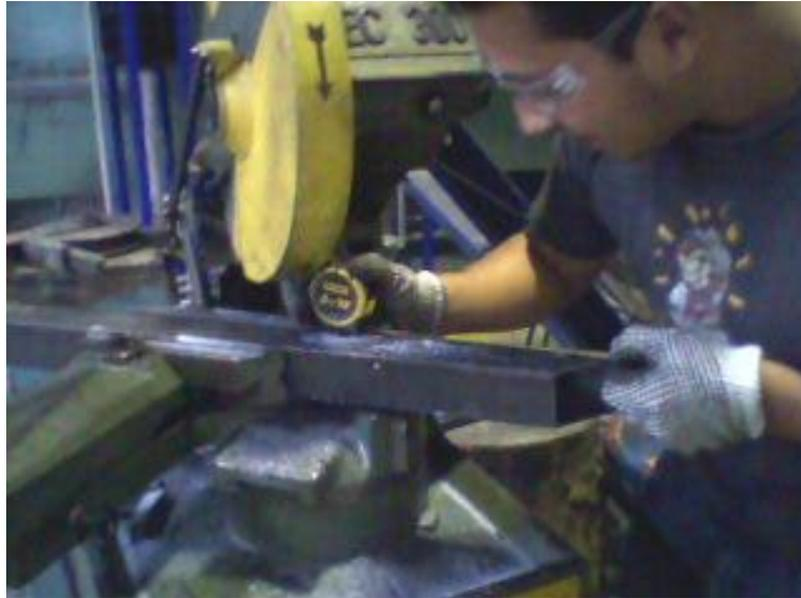
Figura 2-87: Corte de los nervios para solidificar las estructuras
