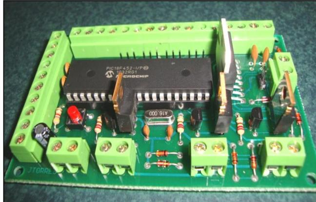
Foto 5: Tarjeta de interface para sensores de bajo voltaje
