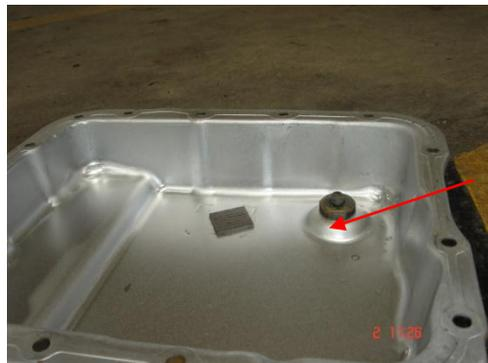
**NOTA:** El tapón del cárter es imantado, para separar partículas y limallas producidas por el desgaste de los elementos, del aceite hidráulico, esto
