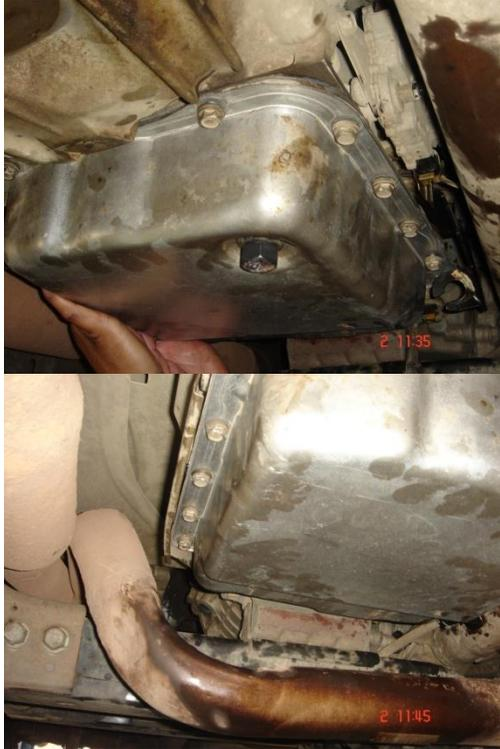
**NOTA:** Nunca se debe utilizar algún tipo de sellante, como silicón. Estos pueden obturar las válvulas, conductos, etc.
