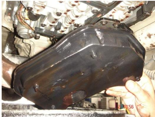
Es necesaria la extracción del buje del filtro ya que este es el que sujeta correctamente.
