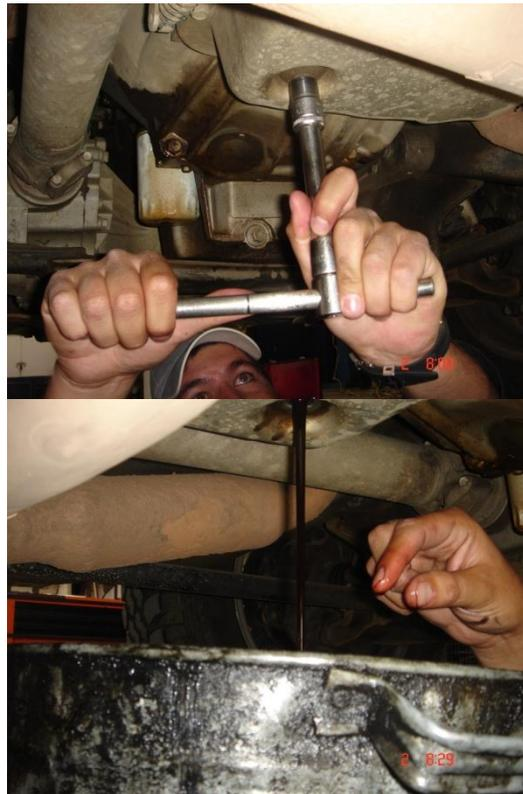
**NOTA:** En los casos de disponer con tapón; este sirve únicamente para facilitar el desmontaje del cárter. ¡Siempre se debe bajar este elemento! Ya que en el cambio del aceite, la exigencia del fabricante implica sustituir el filtro por uno nuevo.
