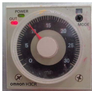
Figura 3.10 Temporizador, ajuste manual de tiempo
