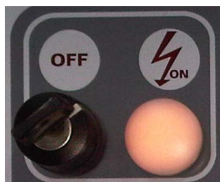
Figura 3.3 Interruptor encendido y apagado del cuadro de mandos
