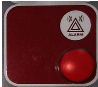
Figura 3.8 Pulsante para pausar momentáneamente el funcionamiento del horno.
