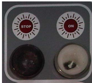
Figura 3.6 Pulsantes para encendido del quemador sistema de circulación de aire caliente. Fuente: Talleres Mirasol S.A.
