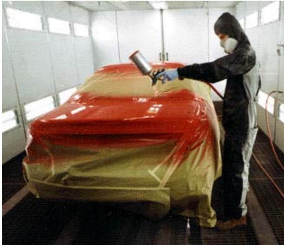
Figura 3.1 Operario dentro de la cabina en fase de pintado.
