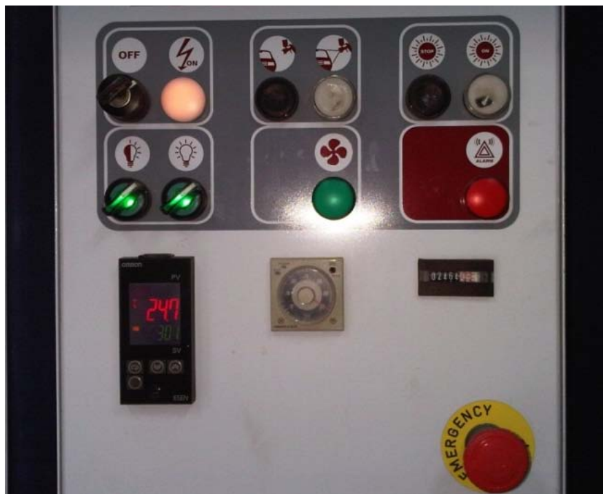
Figura 3.2 Panel de control de un horno Spanesi Omega
