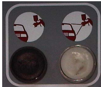
Figura 3.5 Pulsantes para encendido del sistema de aire comprimido sistema de pintado. Fuente: Talleres Mirasol S.A.
