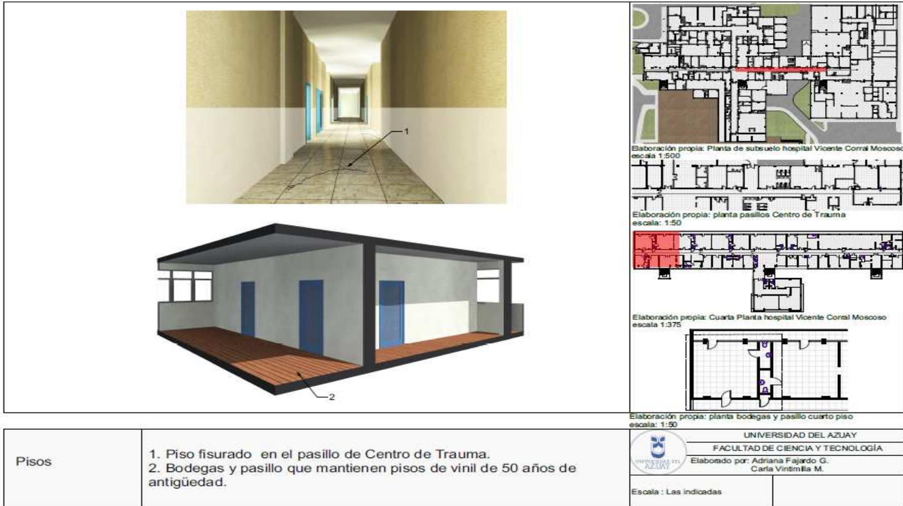
Figura 4.10: Revestimiento en pisos no adecuado.
