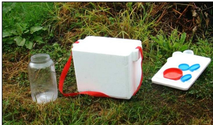
Figura 4.1: Materiales utilizados para la caracterización de las aguas residuales
