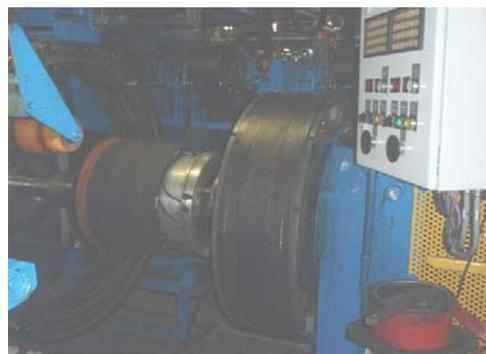
Figura 1.28. Tambor de Construcción Paquete Breaker-Rodamiento.
