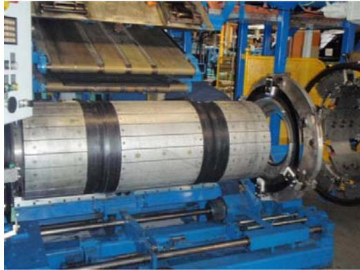
Figura 1.27. Tambor de construcción de la Carcasa.
