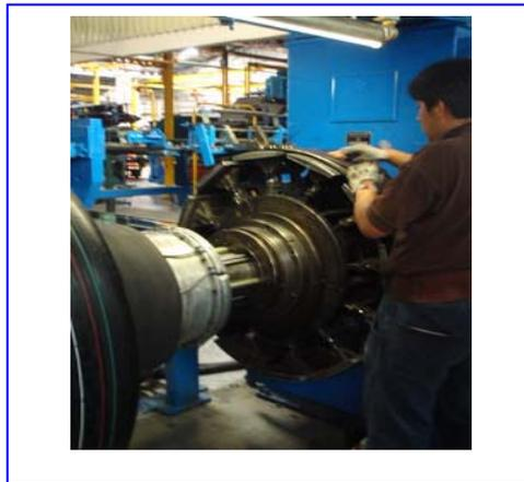
Figura 2.124. Paquete Breaker- Rodamiento.
