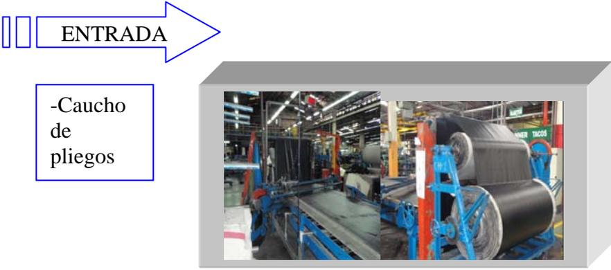
Figura 1.25. Cortadora Horizontal.
