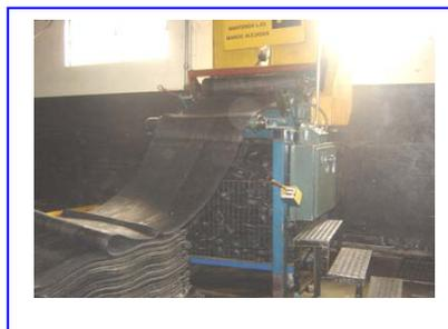
Figura 2.102. Slitter de Caucho
