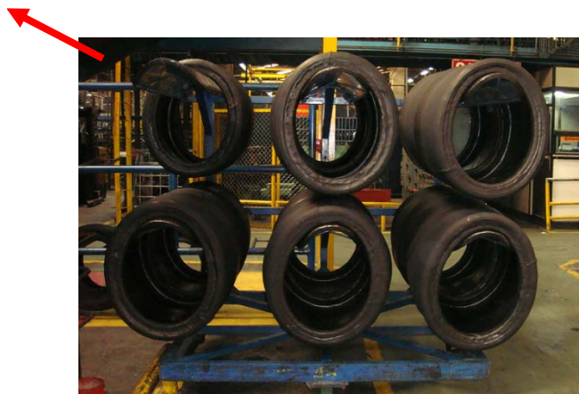
Fotografía 3.3 Carro transportador de brazos para llantas de camión bias.
