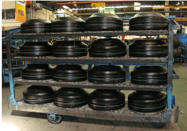
Fotografía 3.5: Carro transportador para llantas de camioneta y pasajero radiales.
