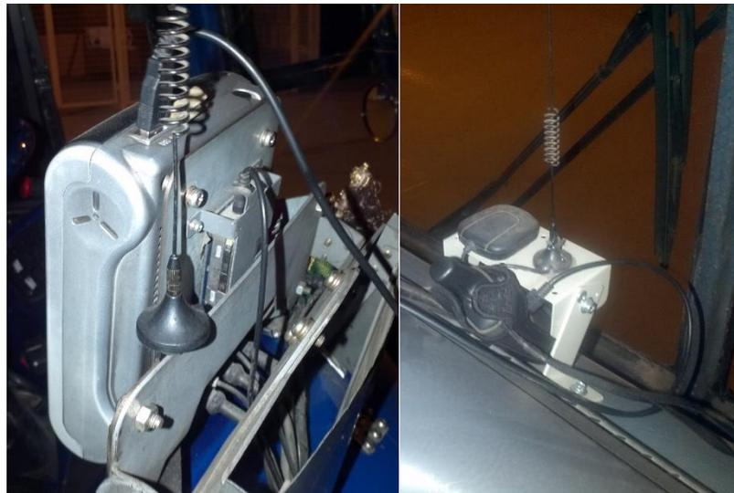
Figura 31. Alimentación externa entre Consola del Conductor y navegador GPSmap® 60CSx
