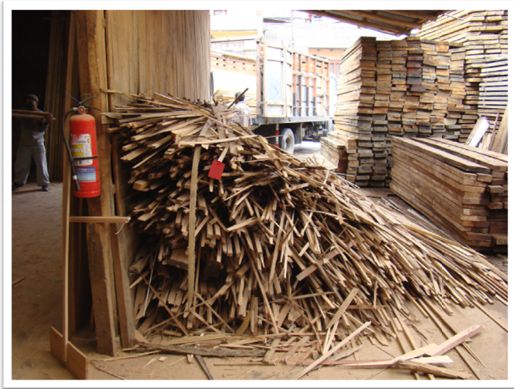
Fotografía 16. Sobrantes y material de desecho obstruyendo la salida de la planta
