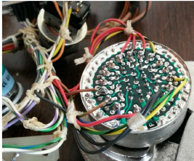
Figura 5.7 Conector hembra del cable MIL-C-3432E con sus conexiones originales.
