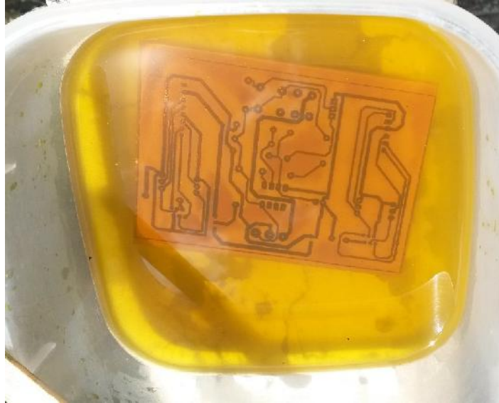
Figura 5.4 Uso de cloruro férrico para obtener el circuito impreso.
