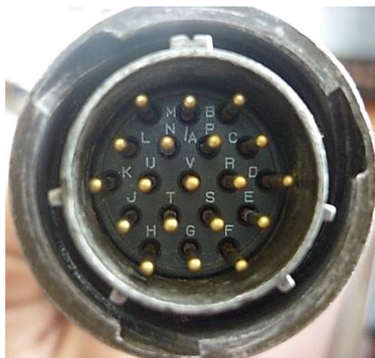
Figura 4.54 Conector y distribución de pines cable MIL-C-3432E.
