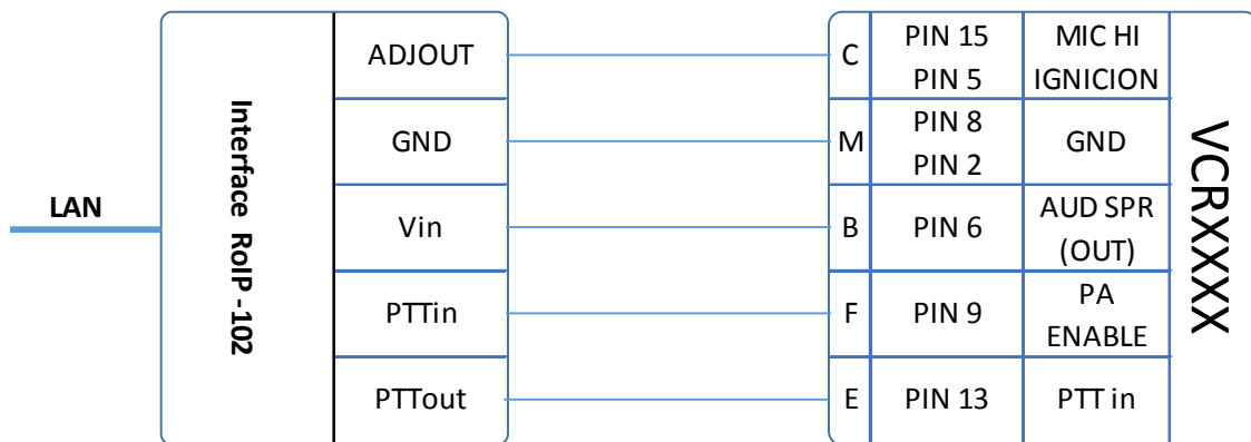
Figura 4.53 Conexiones entre cable MIL-C-3432E y la radio base 1.
