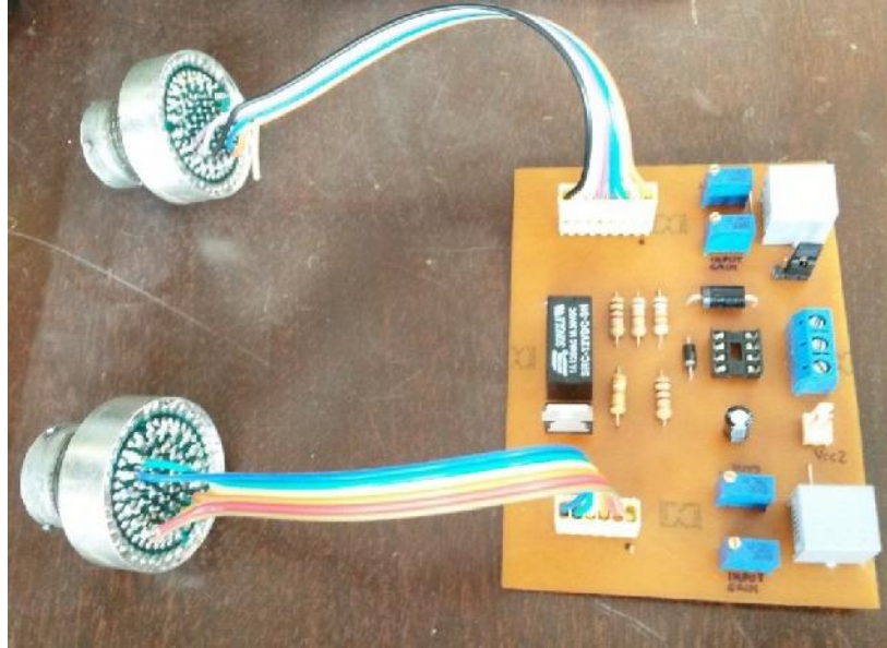
Figura 5.9 Placa final para interface de equipos RoIP-102 .
