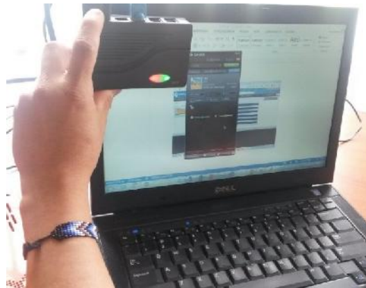
Figura 5.25 PTT entre portátil y RoIP-102
