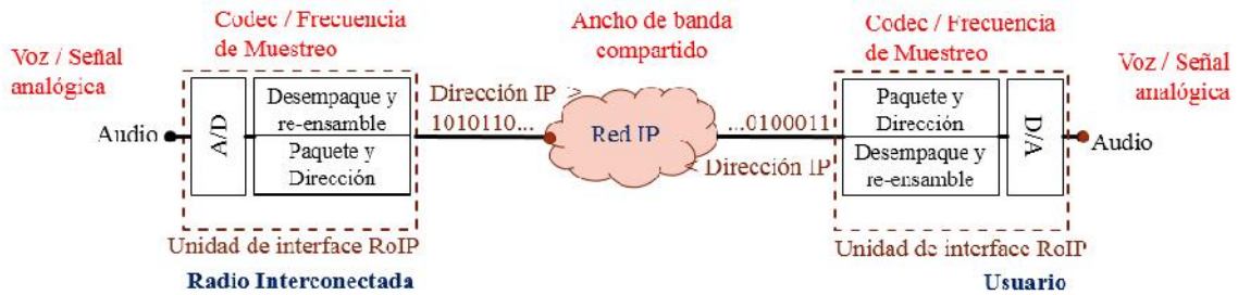
Figura 4.2 Diagrama de bloques RoIP.
