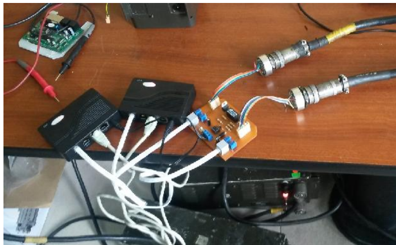
Figura 5.10 Prueba del interface, previo montaje dentro de la caja del relé.
