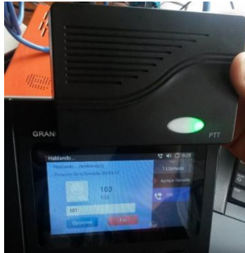
Figura 5.27 PTT entre Teléfono IP y RoIP-102.
