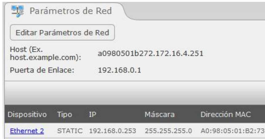
Figura 4.22 Configuración de puerto Ethernet en Central Elastix.
