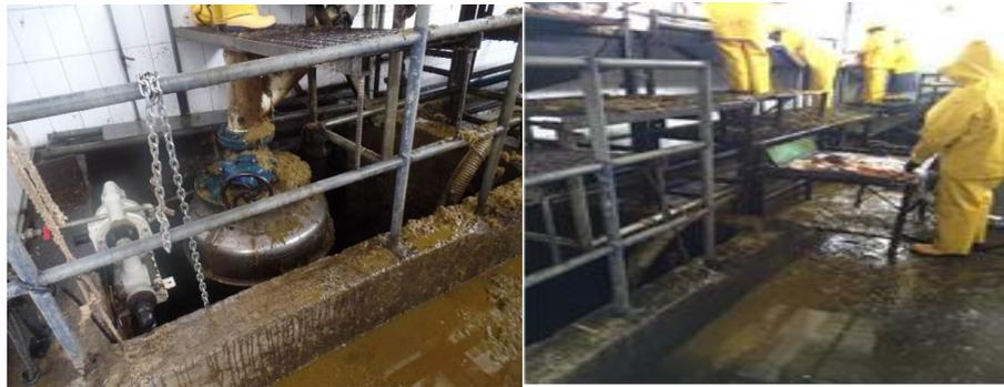
Figuras: 6.3.5 y 6.3.6. Recolección e impulsión de contenido ruminal a planta de compostaje
