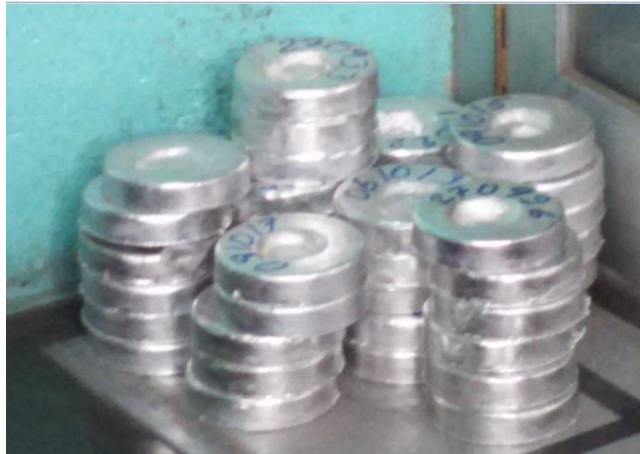
Figura 1.16 Probetas normalizadas para las pruebas de composición de la colada en el espectrómetro de emisión atómica.
