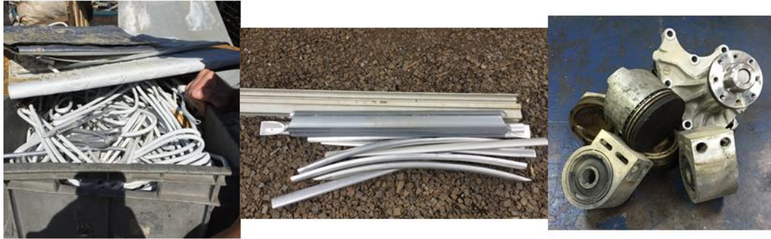
Figura 3.2 Aluminio estructural, perfilería y aluminio grueso.
