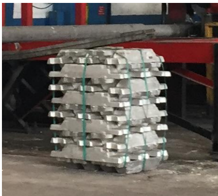
Figura 1.10.- Imagen Aluminio Puro –importado- que se utiliza en la producción de perfilería de aluminio en la empresa Cedal S.A.
