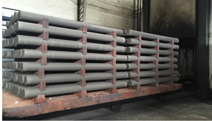
Figura 1.19 Cilindros aluminio homogenizados.
