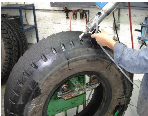
Figura 2.34. Aplicación de Cinta-Relleno
