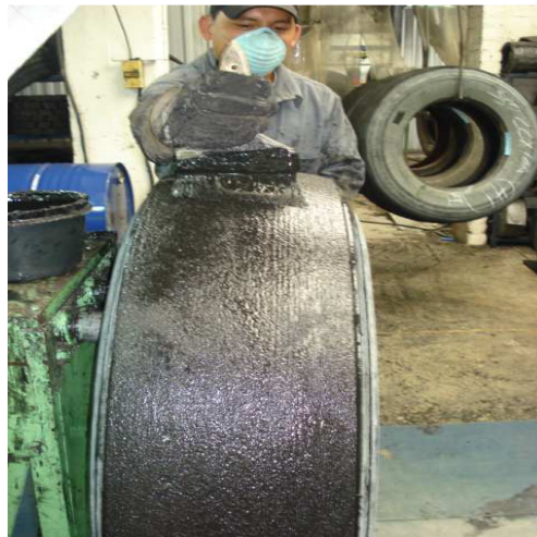
Figura 2.33 Aplicación de Cemento
