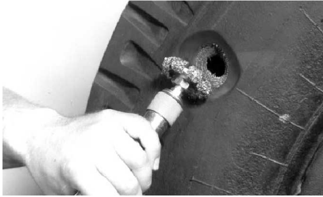
Figura 2.25. Preparación de Herida Reparada
