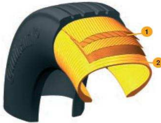
Figura 2.4. Construcción Neumático Radial
