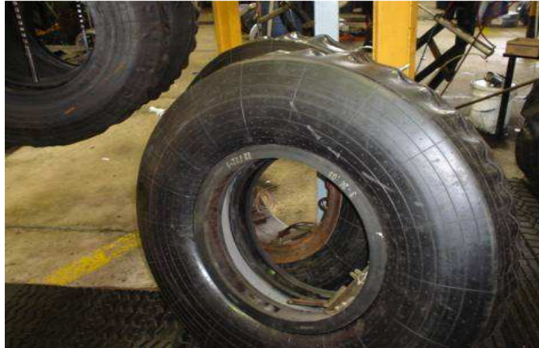
Figura 2.39. Armado con Anillos
