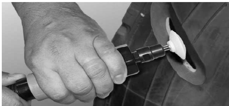
Figura 2.23. Pulido para Reparación
