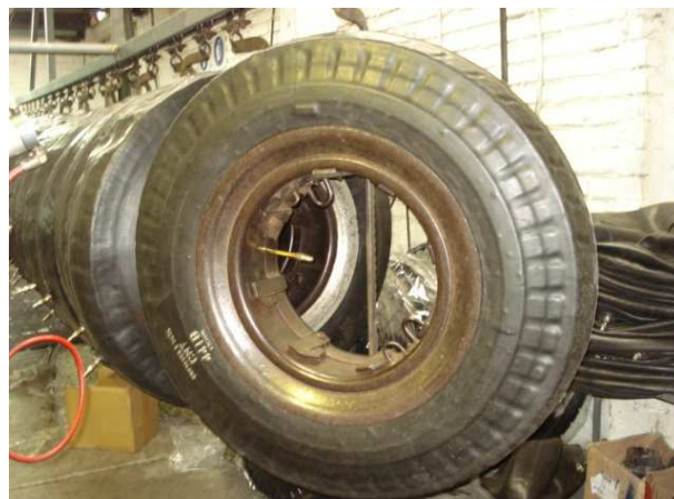
Figura 2.37. Armado de Llanta con Envelope, Aro, Tubo y Defensa
