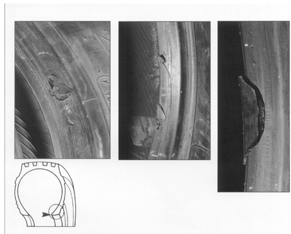
Figura 2.18. Rotura de Pestaña
