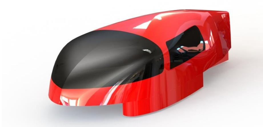
Figura. 2.11 Modelado final de parabrisas y ventanas de propuesta 1.
