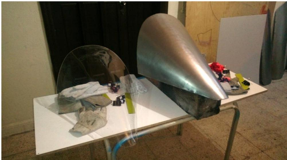
Figura 4.15 Resultado final de termo formado de parabrisas.
