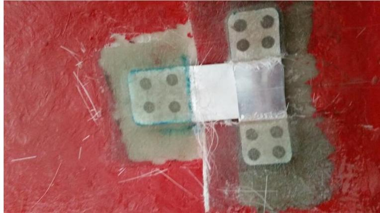
Figura 4.7 Anclajes de carrocería.
