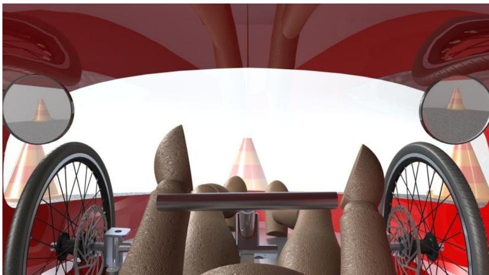
Figura. 2.17 Prueba de visibilidad de retrovisores.
