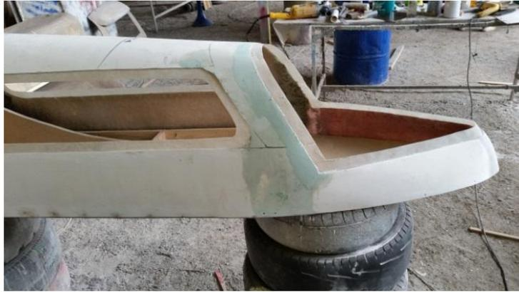
Figura 4.5 Cejas de parabrisas y ventanas.
