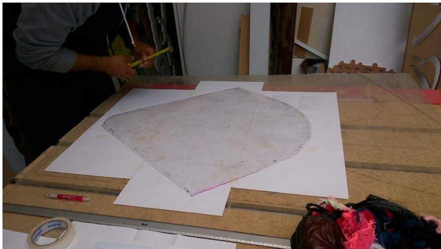
Figura 4.10 Molde de parabrisas en acetato.
