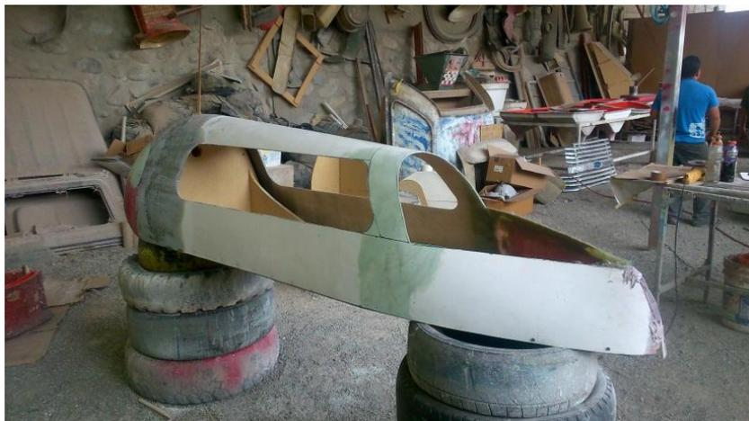
Figura 4.4 Carrocera con cortes de parabrisas y ventanas.
