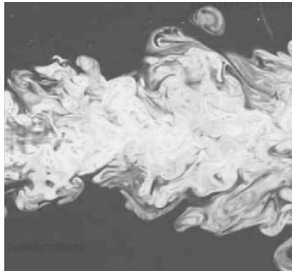
Figura.1.13. Flujo turbulento.
