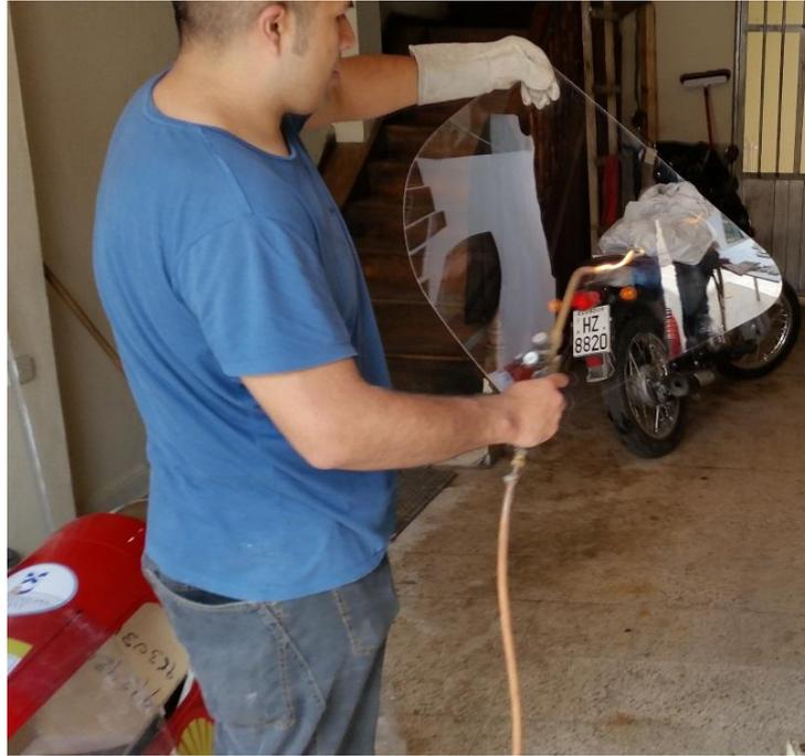
Figura 4.14 Aplicación de calor a molde mediante soplete a moldede parabrisas.
