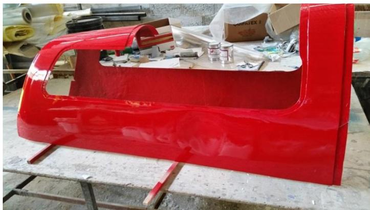
Figura 4.6 Acabado final de pintura de carrocería.
