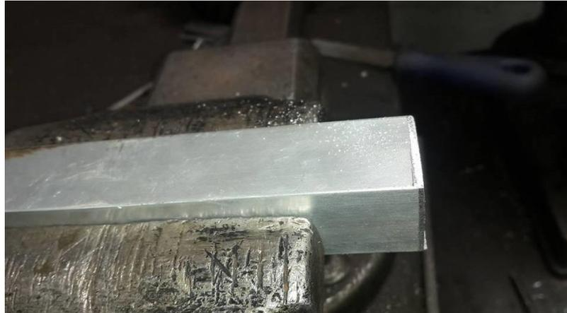
Figura 4.11 Chaflanado de un perfil sección cuadrada mediante limado.
