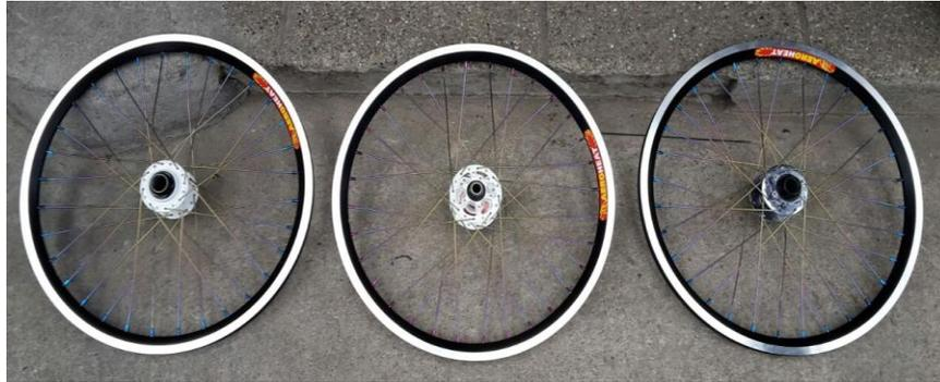
Figura 3.1 Aros de 20 pulgadas seleccionados para utilizar en el prototipo de competencia Shell Eco Marathon.
