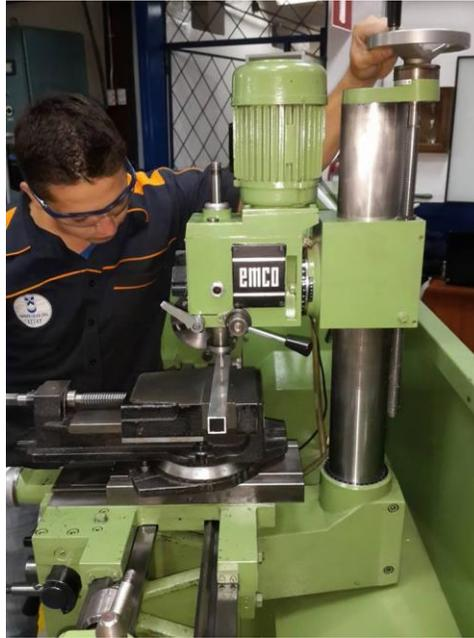
Figura 4.5 Proceso de fresado, ranuras en el perfil cuadrado (optimización de peso).
