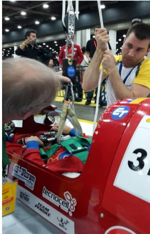
Figura 4.27 Inspección técnica: Resistencia de los puntos de sujeción de los cinturones de seguridad.
