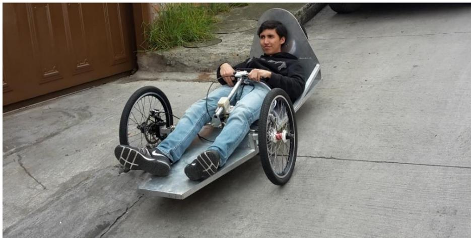
Figura 4.23 Prueba dinámica de descenso para la validación del chasis.
