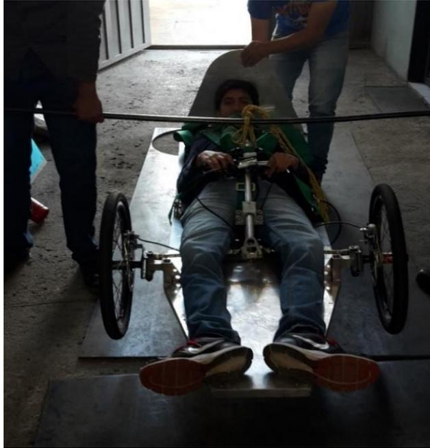
Figura 4.24 Prueba de resistencia en los puntos de anclaje de los cinturones de seguridad previo a la competencia.
