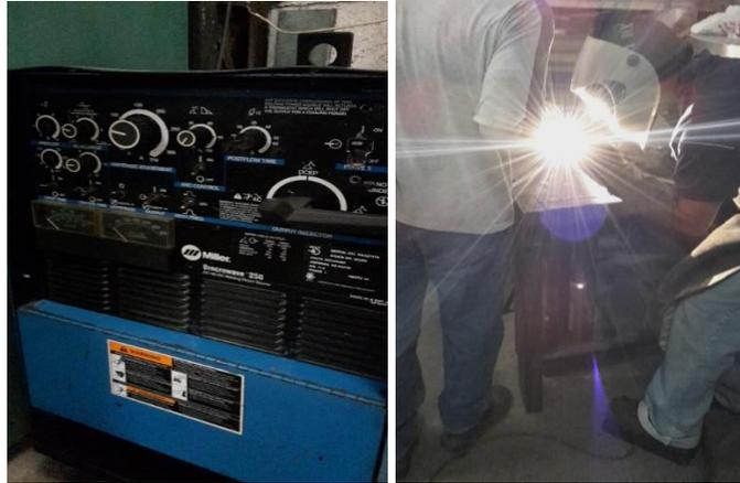
Figura 4.13 Máquina soldadora TIG y ejecución de la soldadura realizado en el chasis de aluminio diseñado.
