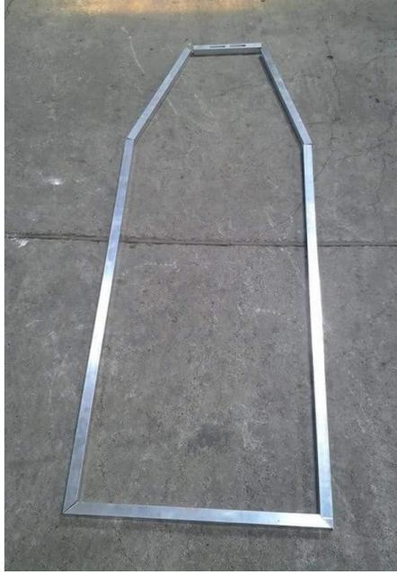
Figura 4.12 Ensamble de la estructura del chasis previo al proceso de soldadura.
