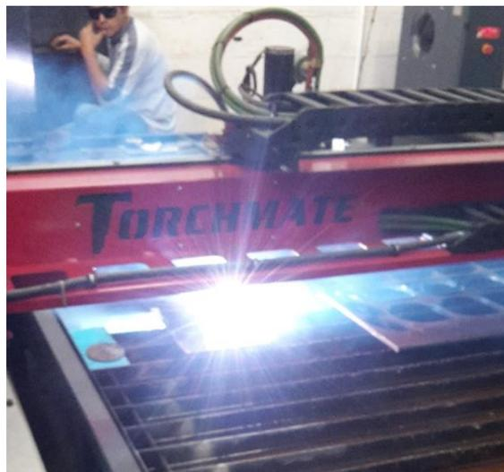
Figura 4.2 Corte mediante plasma CNC de la lámina de 6 mm para el soporte posterior.
