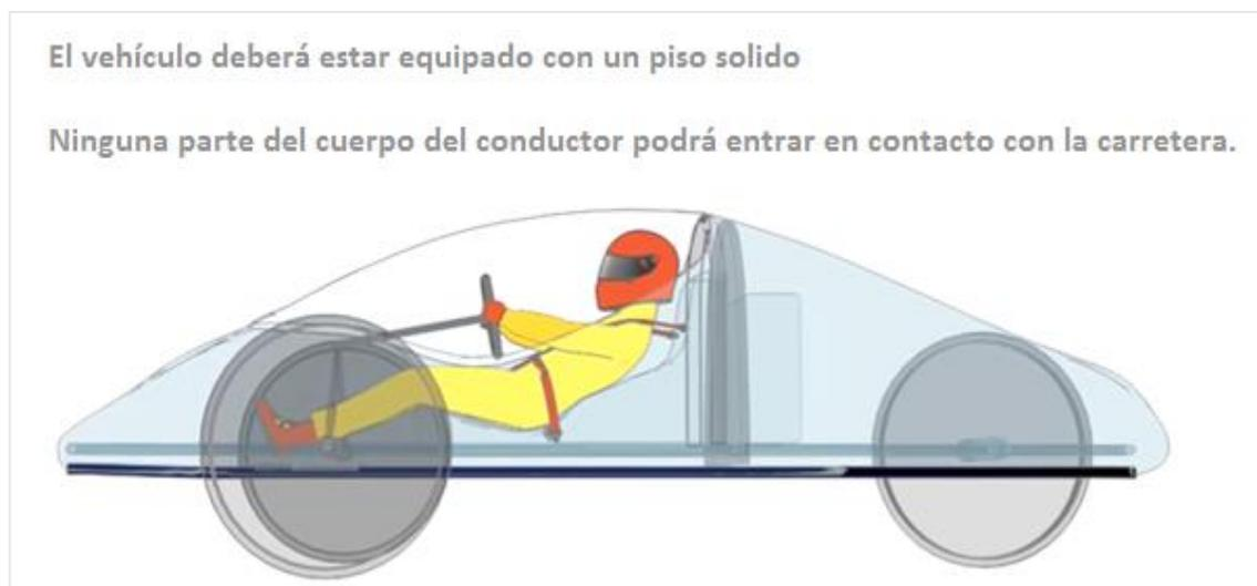
Figura 2.1 Piso sólido del vehículo según la normativa Shell Eco- Marathon.
