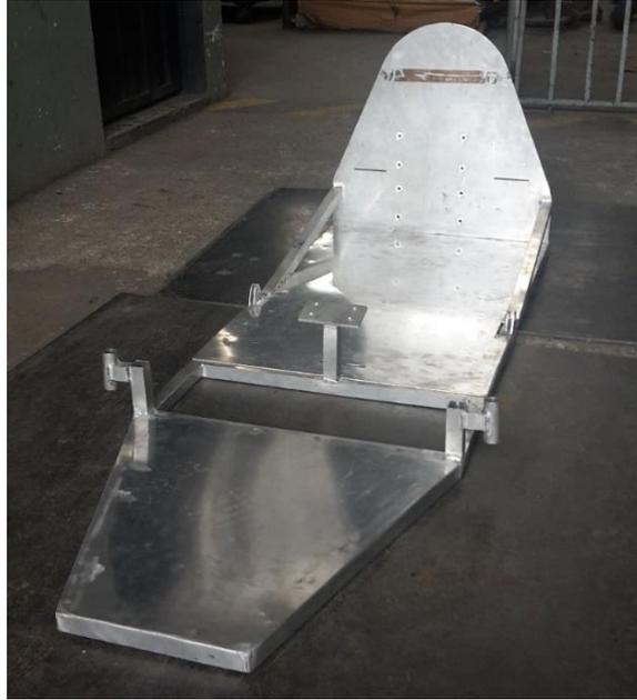
Figura 4.17 Proceso de soldadura del chasis “segunda etapa”.
