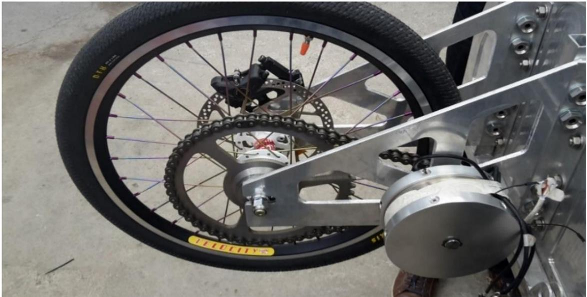
Figura 4.21 Ensamblaje del soporte posterior.
