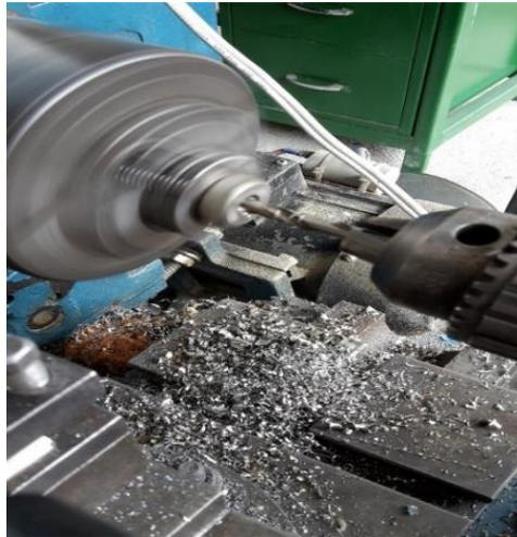
Figura 4.19 Taladrado de pernos de sujeción mediante un torno.
