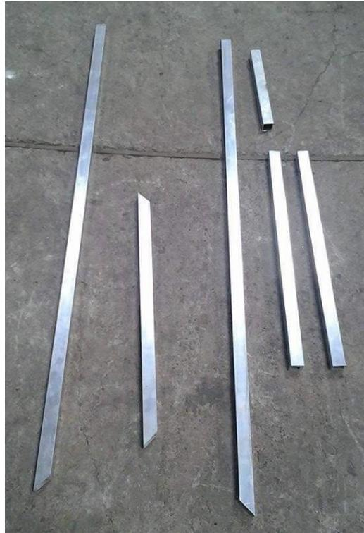
Figura 4.1 Perfiles tubulares cortados a sobre medida.
