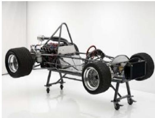
Figura 1.2 Chasis tipo multitubular
