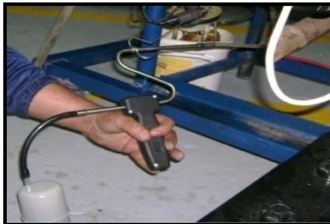
Figura 4.19. Sensor de oxígeno externo
