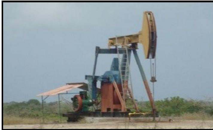
Fotografía 1.2. Bomba de extracción estacionaria
