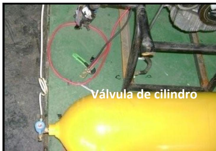
Fotografía 3.3. Válvula de cilindro
