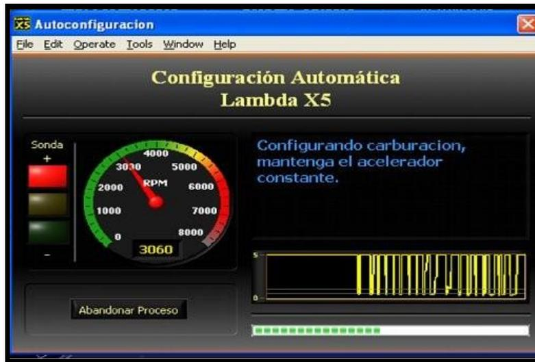
Figura 4.3. Configuración Válvula reguladora de caudal a 3000 rpm
