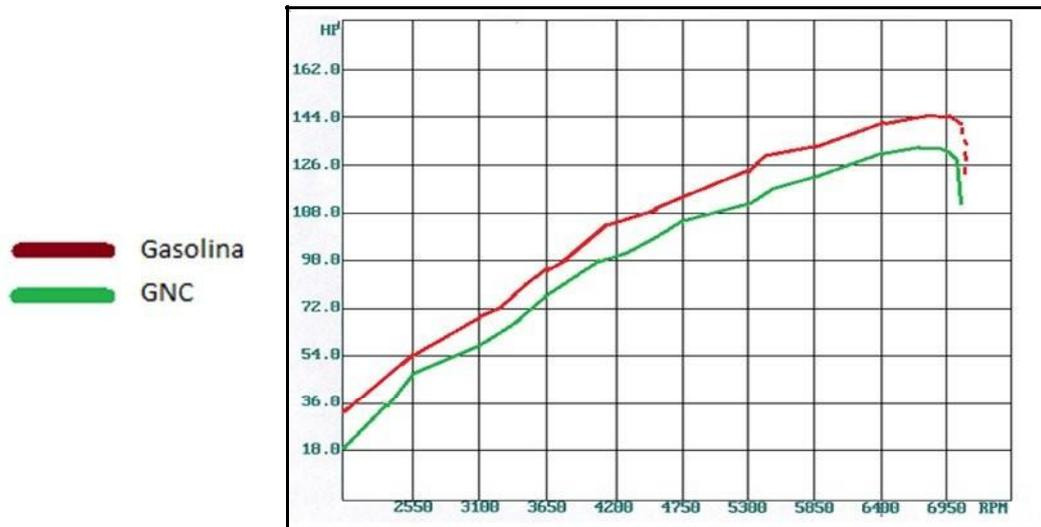
Figura 5.8. Curva comparativa de potencia entre gasolina y gas
