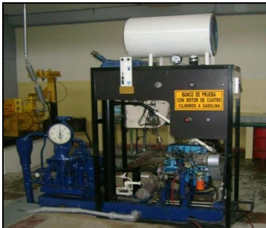
Fotografía 2.1. Banco dinamométrico estático hidráulico.
