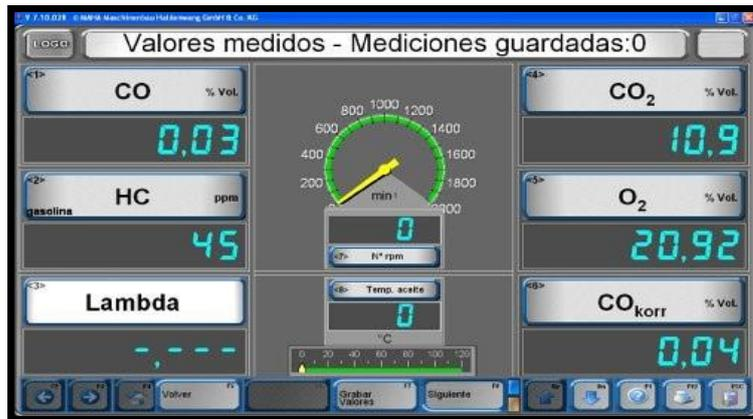
Figura 4.20. Prueba a 2500 RPM CTTE
