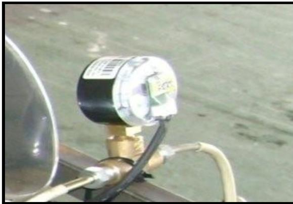
Fotografía 3.4. Manómetro de presión
