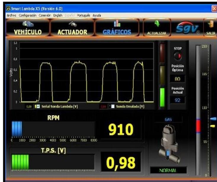
Figura 4.9. Gráfico Señal Sensor LAMBDA
