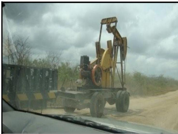
Fotografía 1.5. Bomba de extracción móvil.
