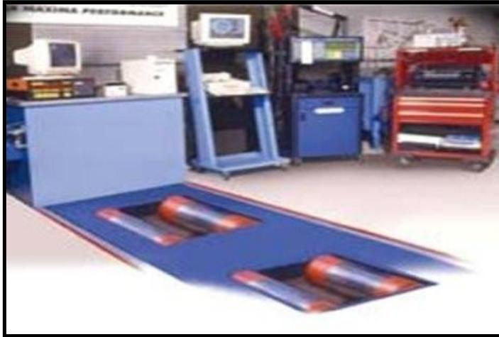
Figura 2.1. Banco dinamométrico de rodillos.
