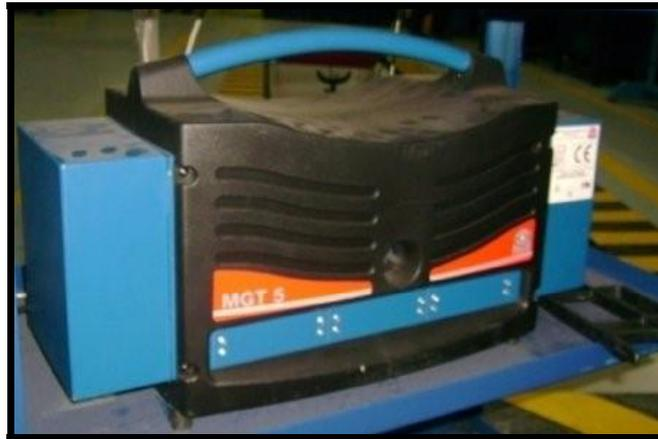
Figura 4.18. MGT 5 Analizador de emisiones contaminantes
