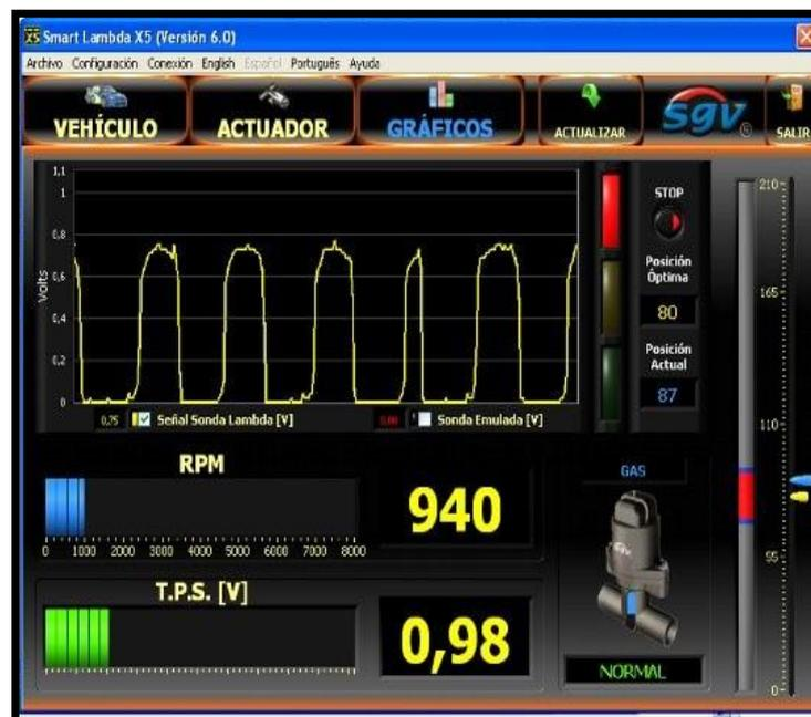
Figura 4.10. Gráfico Señal Sensor LAMBDA
