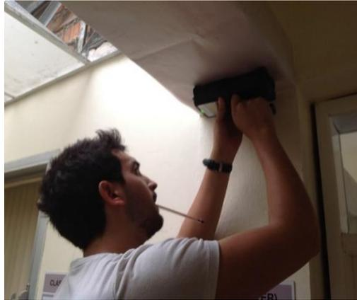
Figura 1.21: Escaneo de armadura
