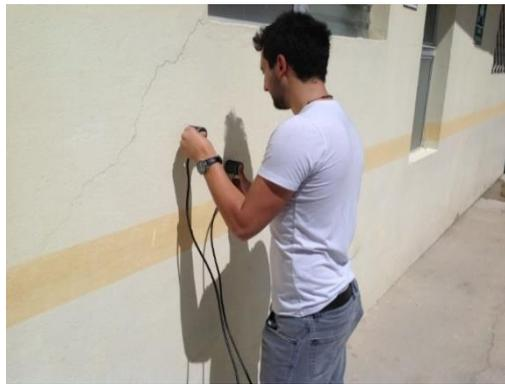
Figura 1.40: Prueba de ultrasonido
