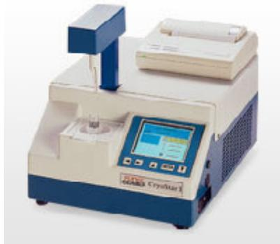
**Gráfico 3.3: Crioscopio. “CryoStar Funke-Gerber“**
