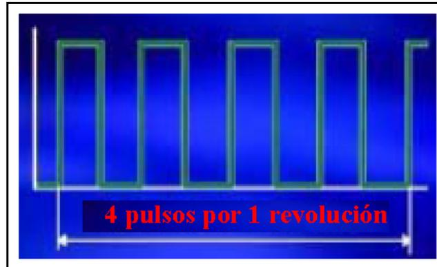
*Figura 23: Señal del Sensor de Velocidad*
