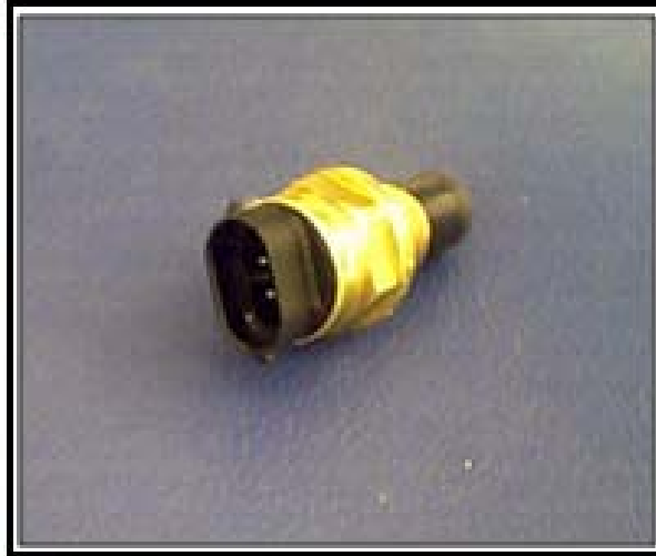
Fig. 2-17. Estructura del Sensor VSS
