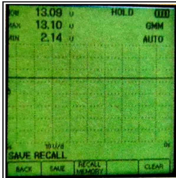
Fig. 2-21 Señal de Referencia del Sistema de Encendido DIS
