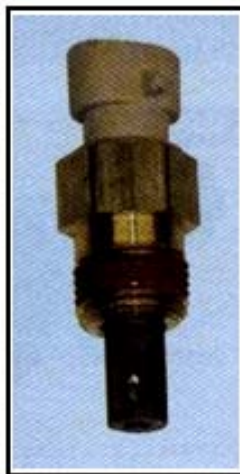
Fig. 2-8. Estructura del Sensor CTS
