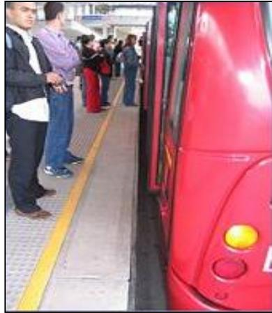
Figura 1.11. Separación entre el autobús y la parada.
