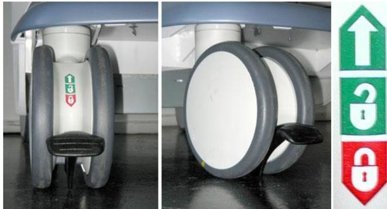
Figura 6. 7 Bloqueo de Dirección. Fuente: Manual GE Healthcare
