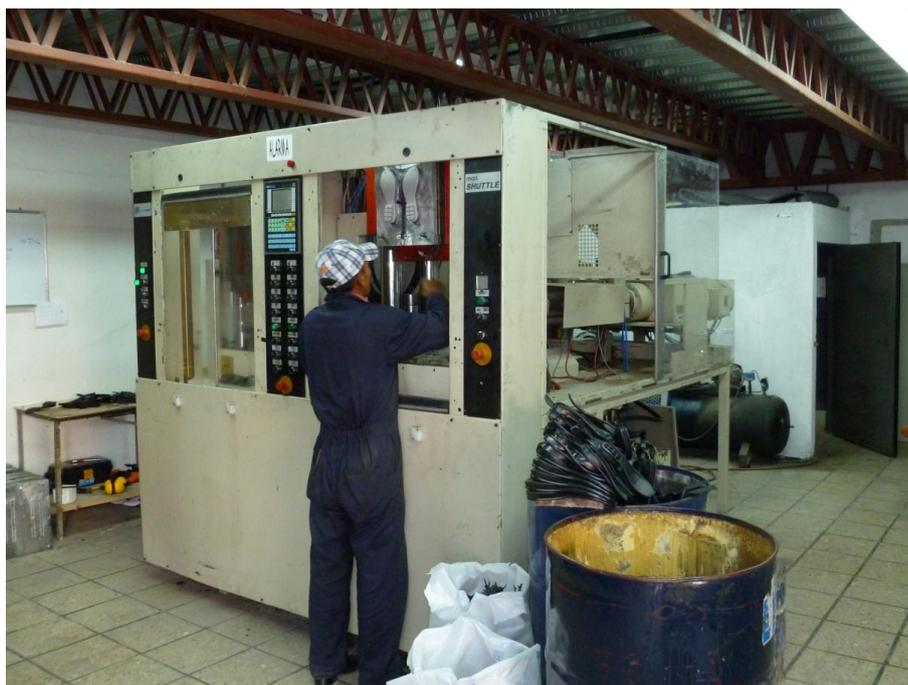
Foto 27: Inyectora vertical de suelas.
