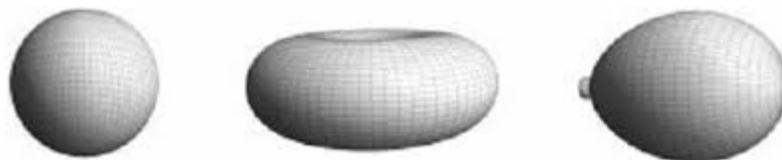
Figura 2.15 Tipos de radiación de las antenas RFID.
