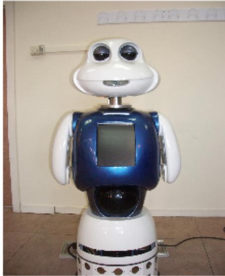
Figura 1.1 Robot controlado por sistema RFID.
