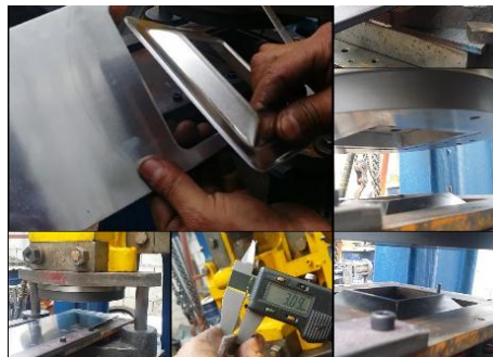
Figura 1.1 Matriz para troquelar y embutir base piramidal de aluminio para tubo cuadrado.
