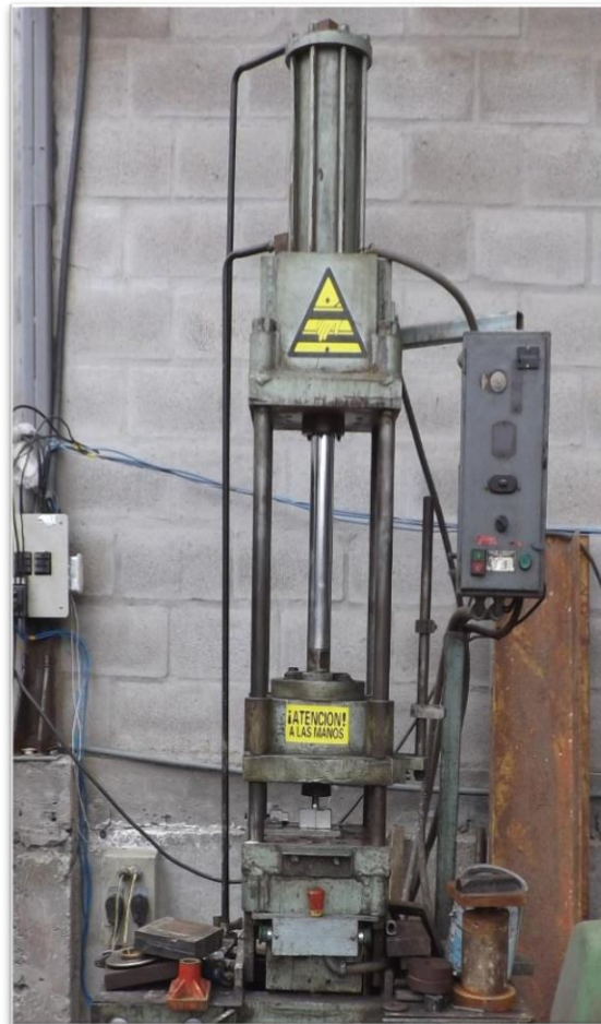
Figura 1.6 Prensa de 30 toneladas, puede usarse para servicio de subcontratación o producción propia.
