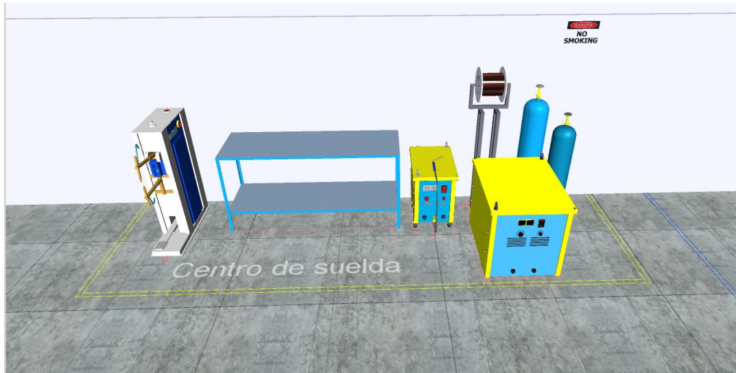
Figura 3.19 Centro de suelda.
