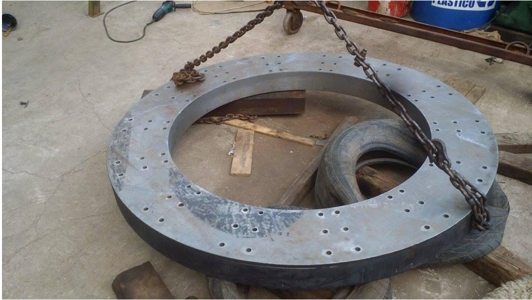
Figura 3.23 Matriz para embutir tapa para tanques de gas estacionario.
