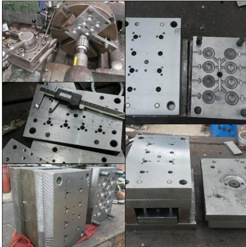
Figura 1.2 Molde para inyección de zámag.
