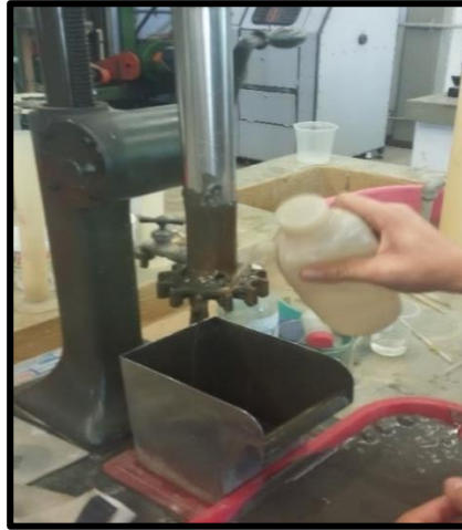
Figura 0.11: Limpieza de la celda de flotación para recuperar todas las colas y llevar a secarlas.
