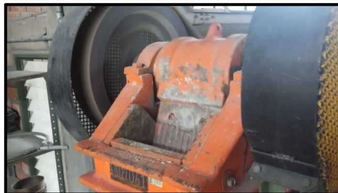
Figura 0.17: Trituradora de Mandíbulas que posee el laboratorio.
