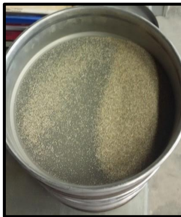
Figura 0.13: Cantidad de material retenido en el tamiz para determinación del set abierto.
