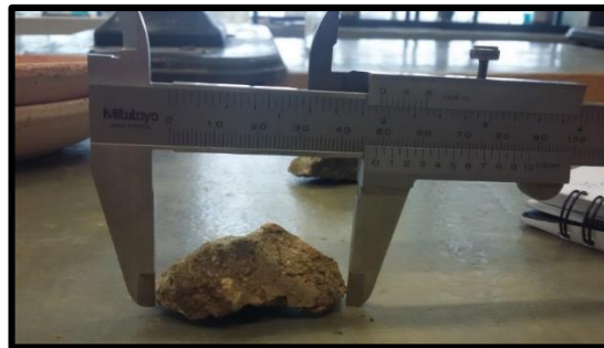
Figura 0.19: Muestra representativa para determinar el set abierto del equipo (48.5mm).
