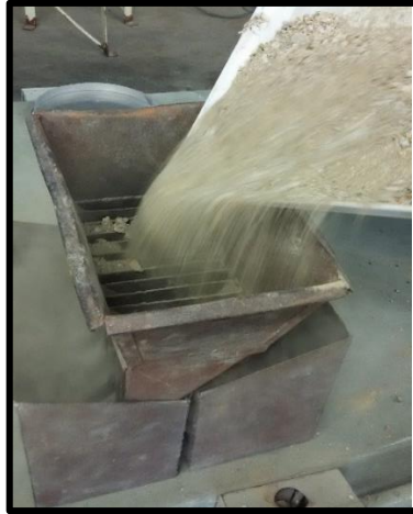
Figura 0.6: Utilización del cuarteador de riffles para trabajar con una muestra representativa.
