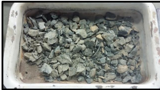
Figura 0.22: Muestra fragmentada por la trituradora de mandíbulas.
