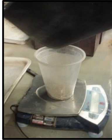
Figura 0.8: Peso del material retenido en cada tamiz.
