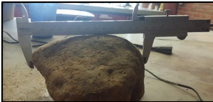
Figura 0.16: Utilización de pie de rey en roca a triturar 132.1 mm de diámetro.
