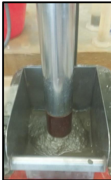
Figura 0.10: Agitación de la pulpa en la celda de flotación Denver.
