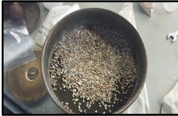
Figura 0.9: Muestra desmontada luego de pasar por el ro - tap.
