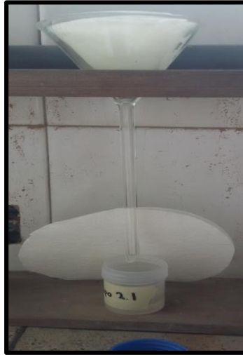
Figura 0.8: Filtración de la pulpa con una cantidad de 30ml.
