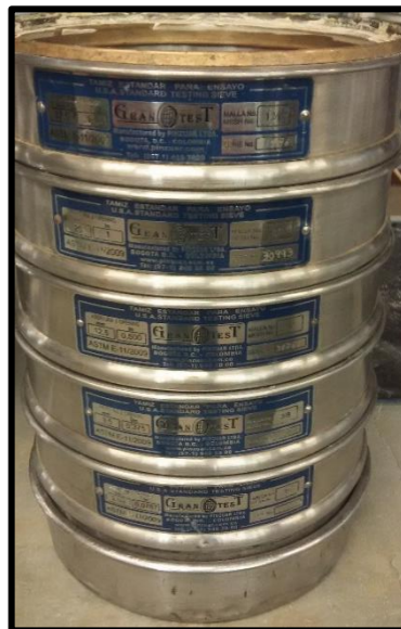
Figura 0.2: Serie de tamices para el análisis granulométrico.
