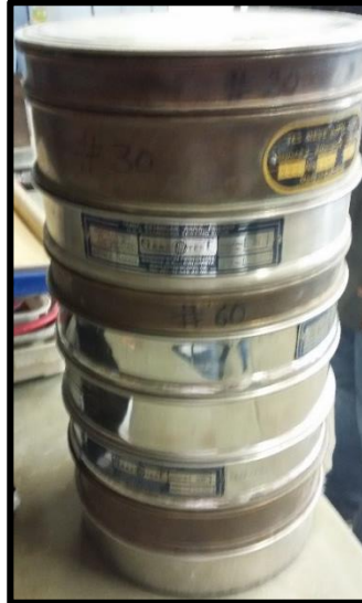
Figura 0.12: Series de tamices de mayor a menor para el cálculo del d_{80} de alimento.
