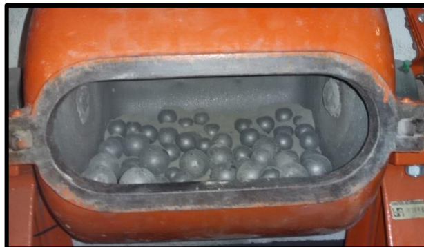
Figura 0.14: Material molido en el molino de bolas.
