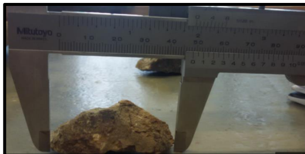
Figura 0.23: Medición muestra característica mayor a malla 3/4 para set abierto.
