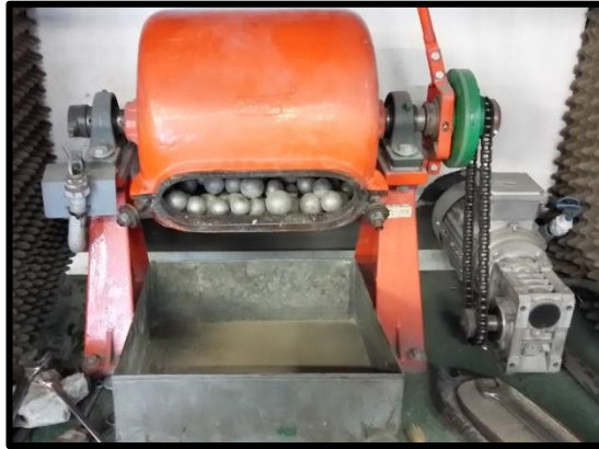
Figura 0.10: Molino de bolas para el ensayo de Bond.
