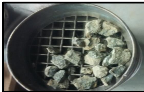
Figura 0.20: Muestra retenida malla # 3/4.
