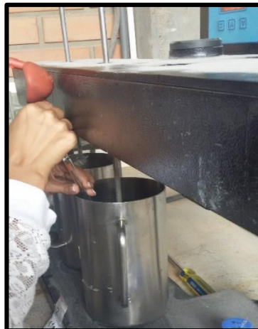
Figura 0.7: Titulación a través de la pulpa obteniendo 30 ml.
