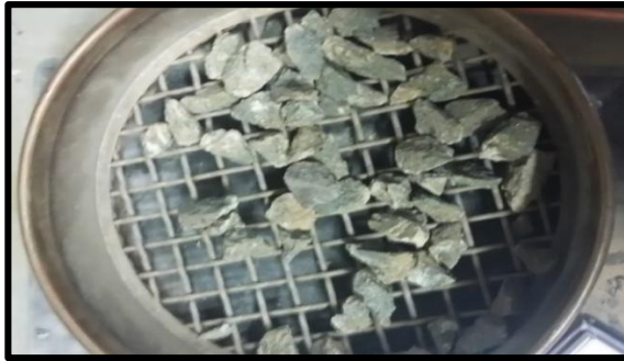
Figura 0.21: Muestra retenida malla # ½.
