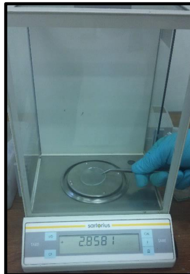
Figura 0.8: Balanza analítica con la que cuenta el laboratorio, para la determinación del peso de cada gota de los colectores y espumante.
