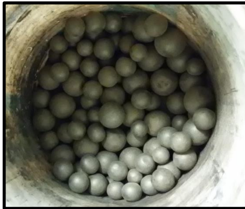
Figura 0.11: Bolas con las que trabaja el molino.
