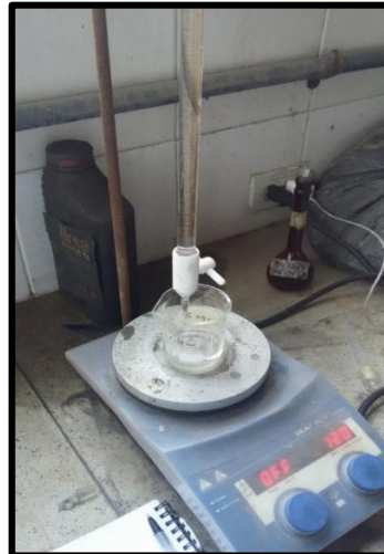
Figura 0.9: Titulación agregando nitrato de plata a 5ml de pulpa.
