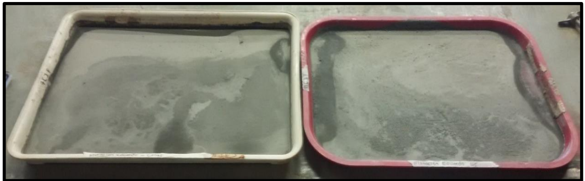
Figura 0.12: Las colas (izquierda) y el concentrado luego de un día de secado.
