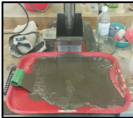
Figura 0.6: El concentrado que superó la celda de flotación para posteriormente ser secado.
