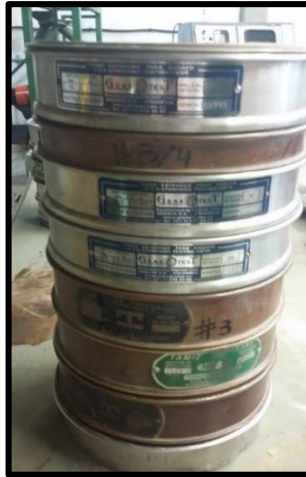
Figura 0.18: Distribución de las mallas a trabajar en el proceso de trituración.
