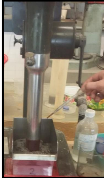
Figura 0.4: Adición de los colectores por goteo en la pulpa.
