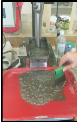
Figura 0.5: Concentrado que superó la celda de flotación.
