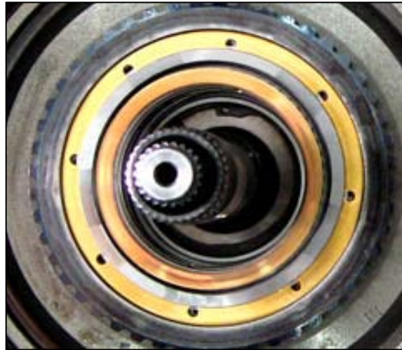
Figura 1.4 Mecanismo de rueda libre
