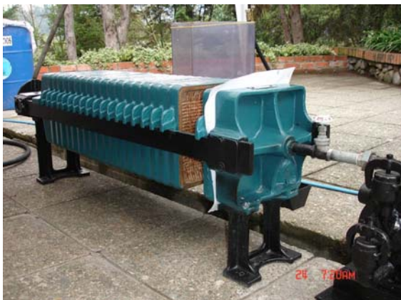
Figura 5: Filtro prensa para deshidratación de lodos
