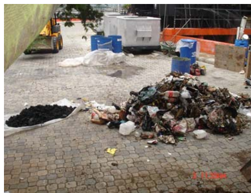
Figura 10: Lodo deshidratado y desechos sólidos para llenado de reactor
