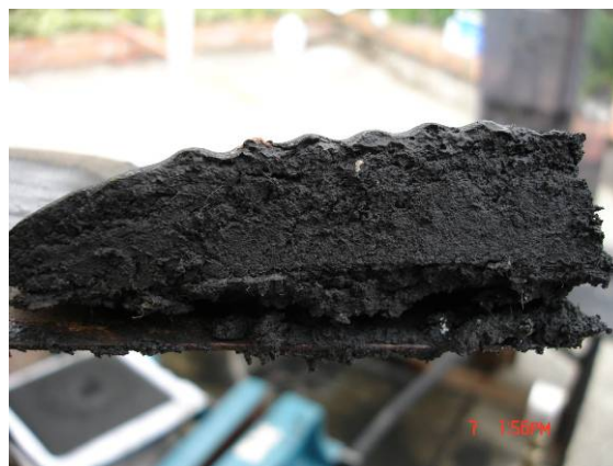
Figura 23: Detalle de lodo deshidratado
