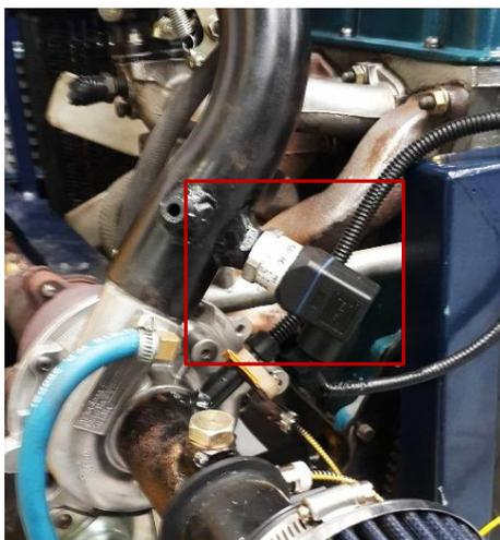
Figura 4. 10. Montaje del sensor de presión P2
