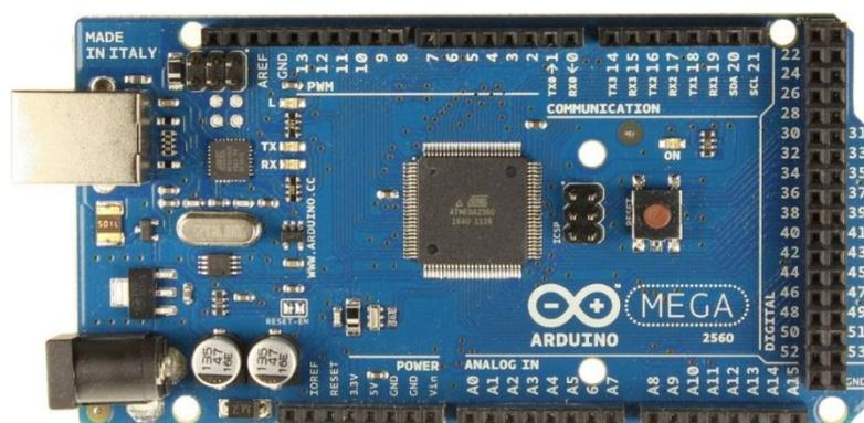
Figura 4. 4. Tarjeta Arduino Mega 2560
