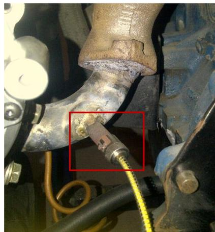
Figura 4. 15. Sensor de temperatura en la entrada de la turbina
