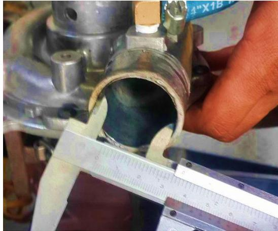
Figura 5. 4. Medida del diámetro de la salida del compresor
