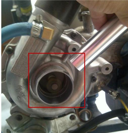
Figura 4. 33. Medición del régimen de giro
