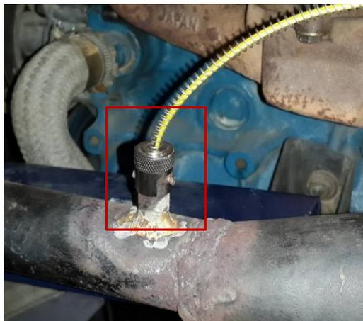
Figura 4. 16. Sensor de temperatura en la salida de la turbina
