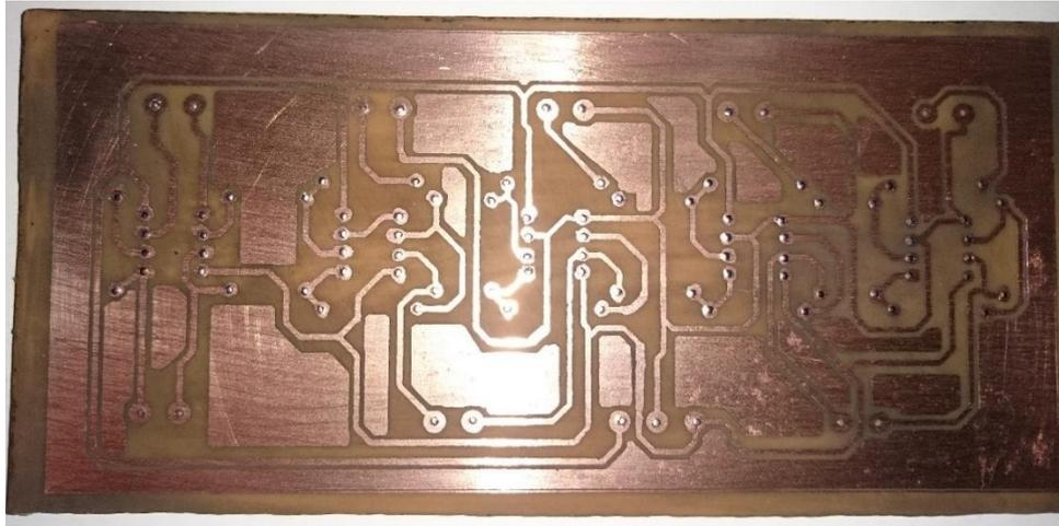
Figura 4. 27. PCB revelado en baquelita
