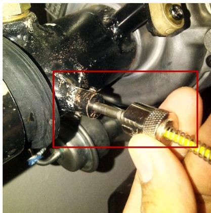
Figura 4. 13. Sensor de temperatura en la entrada del compresor
