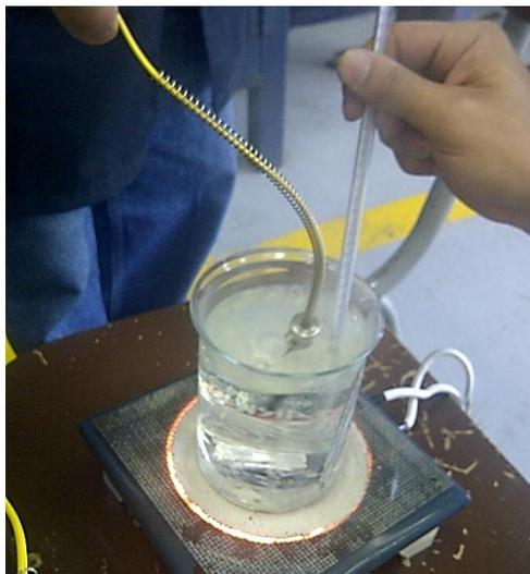
Figura 4. 30. Calibración de la temperatura
