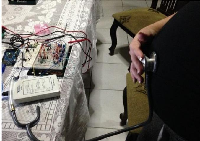
Figura 4.12: Pruebas de circuitos de acondicionamiento.
