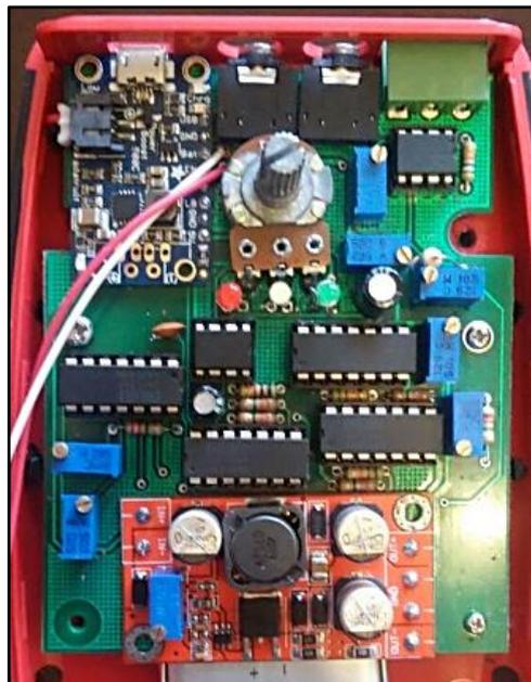
Figura 4.11: Placa final sistema de adquisición de sonidos cardíacos fetales
