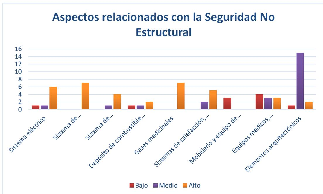
Figura 1.40: Gráfico de tabulación de los aspectos relacionados con la seguridad no estructural. Fuente: Datos del modelo matemático del índice de seguridad hospitalaria.
