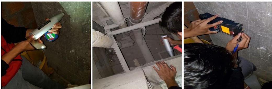
Figura 1.14: Ensayos no destructivos en: columnas, vigas y losas más desfavorables del hospital.
