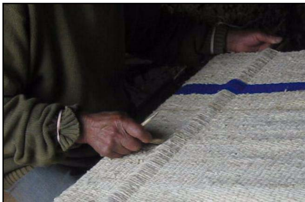
Ilustración 28 "Ajuste de la Trama con el Pikchi" Fuente: Grupo Zhipta, UDA
