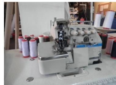
Fig. 7 Máquina Overlock
