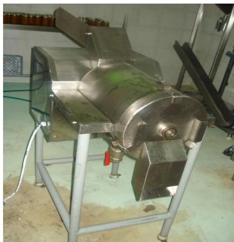
**Ilustración 36 máquina despulpadora**
