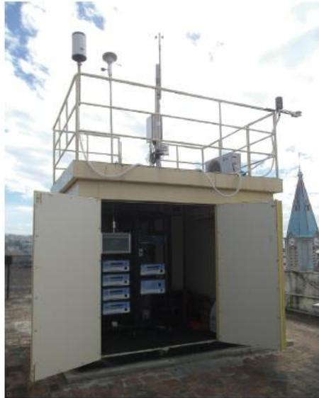
*Ilustración 6 Estación automática de monitoreo (EMOV-EP, 2015)*
