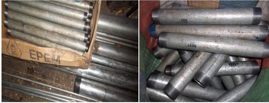
**Figura 2.7 Neplos Almacenados En Diferentes Medidas**
