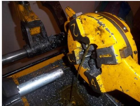
**Figura 2.6 Tubo HG Colocado en Roscadora**
