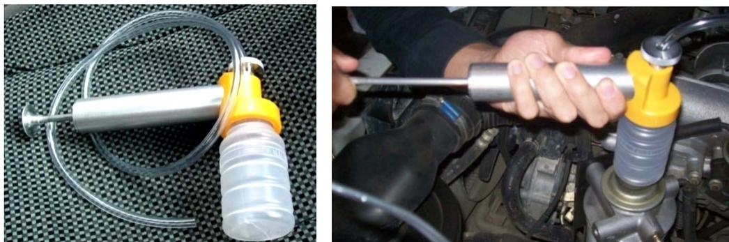
*Fotografía 2.24: Armado de la bomba de vacío (Foto Autor).*
