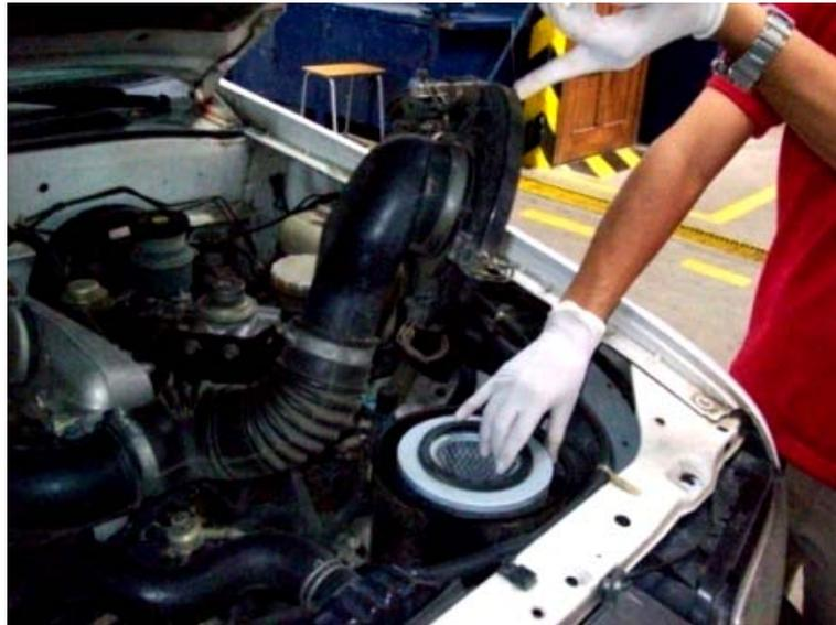
*Fotografía 2.4. Colocación del nuevo filtro de Aire (Foto Autor).*
