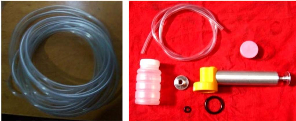
*Fotografía 2.21: Implementos para la extracción de la muestra (Foto Autor).*
