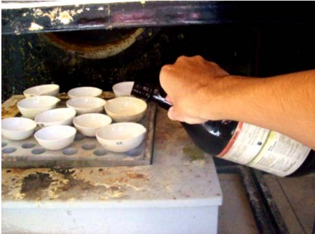
*Fotografía 3.13: Dilución de la muestra quemada con ácido nítrico (Foto Autor).*
