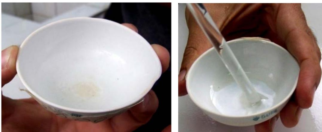
*Fotografía 3.14: Disolución de la muestra quemada con agua destilada (Foto Autor).*
