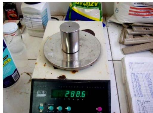
*Fotografía 3.49: Peso del vaso lleno con la muestra (Foto Autor).*
