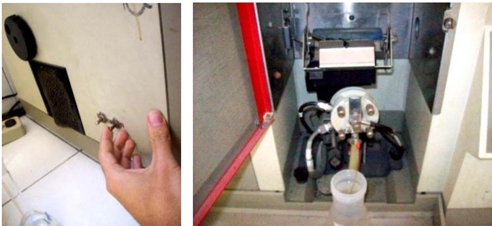
*Fotografía 3.31: Apagado del equipo de absorción atómica (Foto Autor).*
