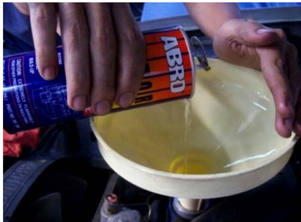
*Fotografía 2.9: Colocación del motor flush (Foto Autor).*
