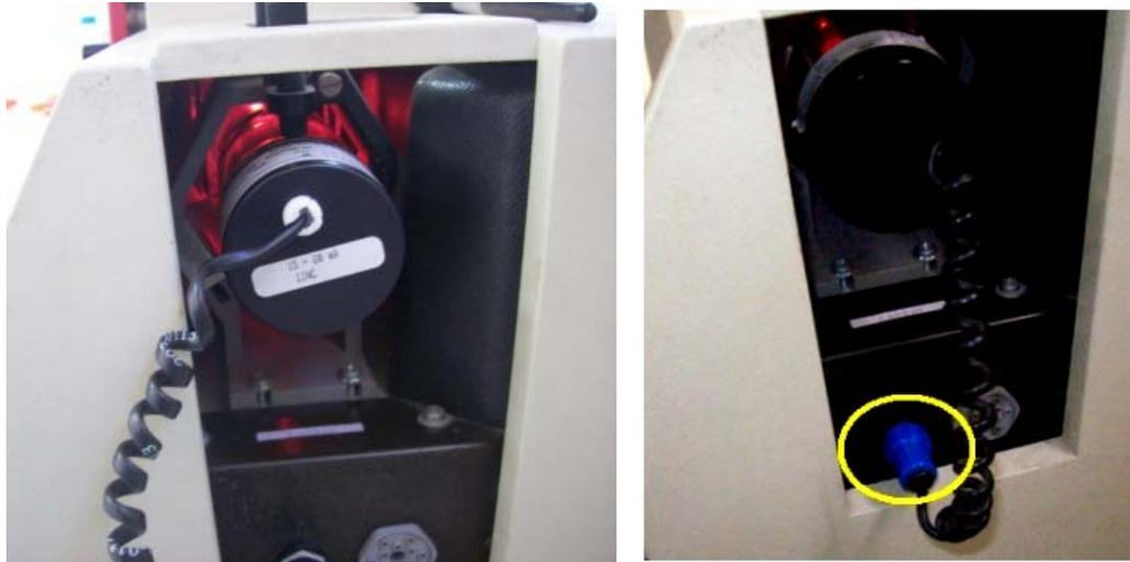
*Fotografía 3.18: Instalación de la lámpara (Foto Autor).*
