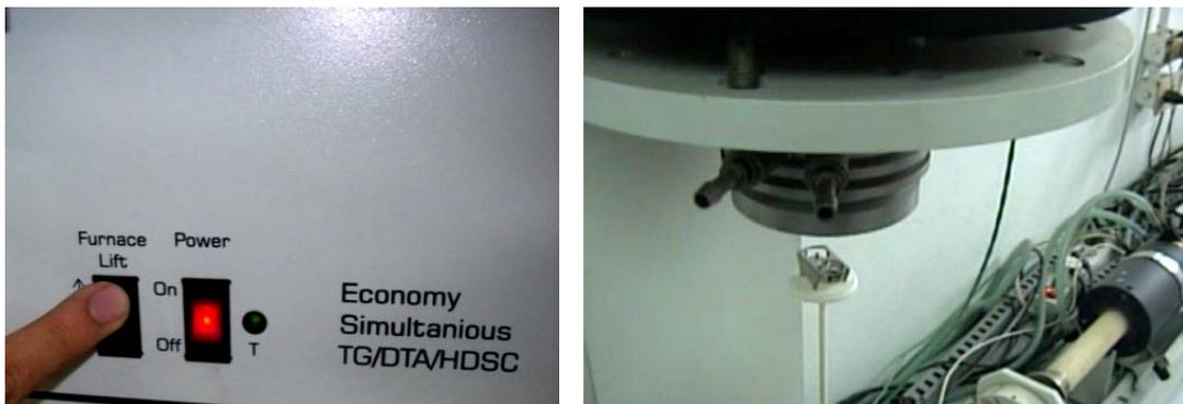
Fotografía 3.70: Accionamiento de lift para el ascenso del horno (Foto Autor).
