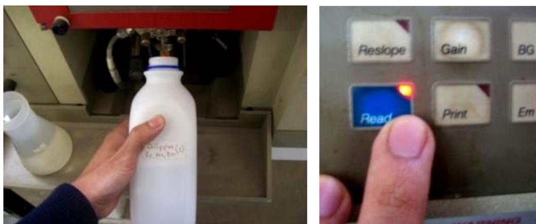
*Fotografía 3.28: Análisis de patrones para la preparación de la curva de calibración (Foto Autor).*
