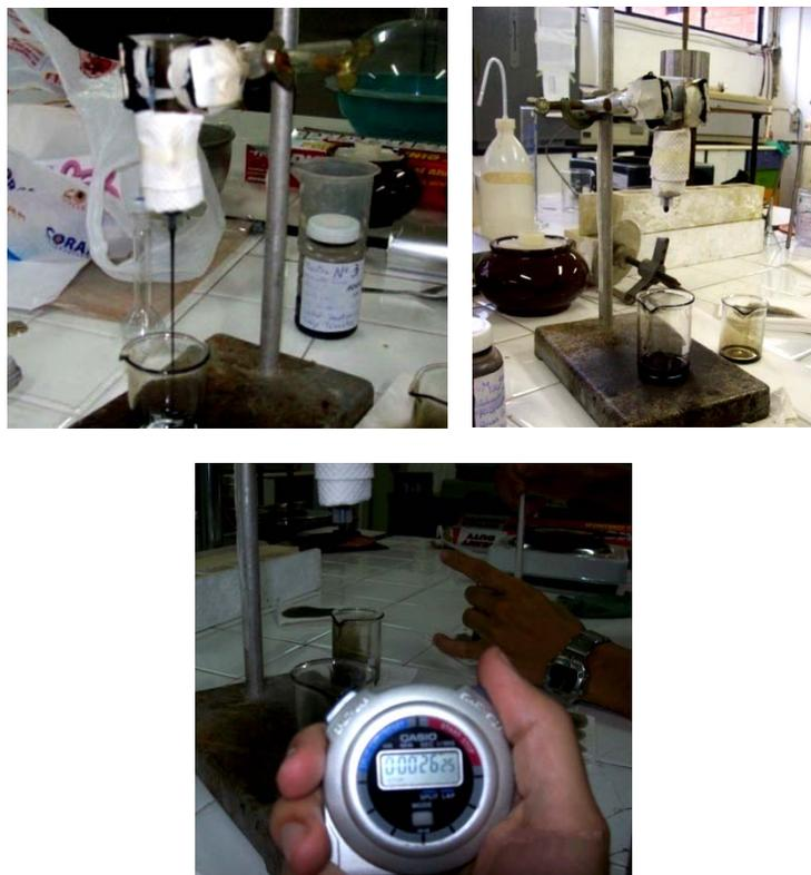
*Fotografía 3.54: Medición del tiempo para el respectivo análisis de la viscosidad (Foto Autor).*
