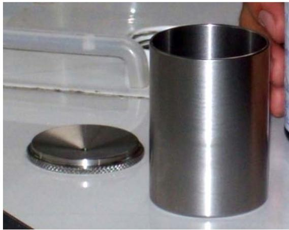
Fotografía 3.45: Vaso de medición calibrado (Foto Autor).
