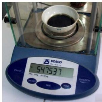
Fotografía 3.5: Pesado del crisol con la muestra (Foto Autor).
