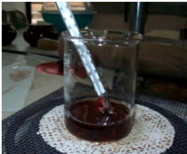
*Fotografía 3.52: Medición de la temperatura de la muestra (Foto Autor).*
