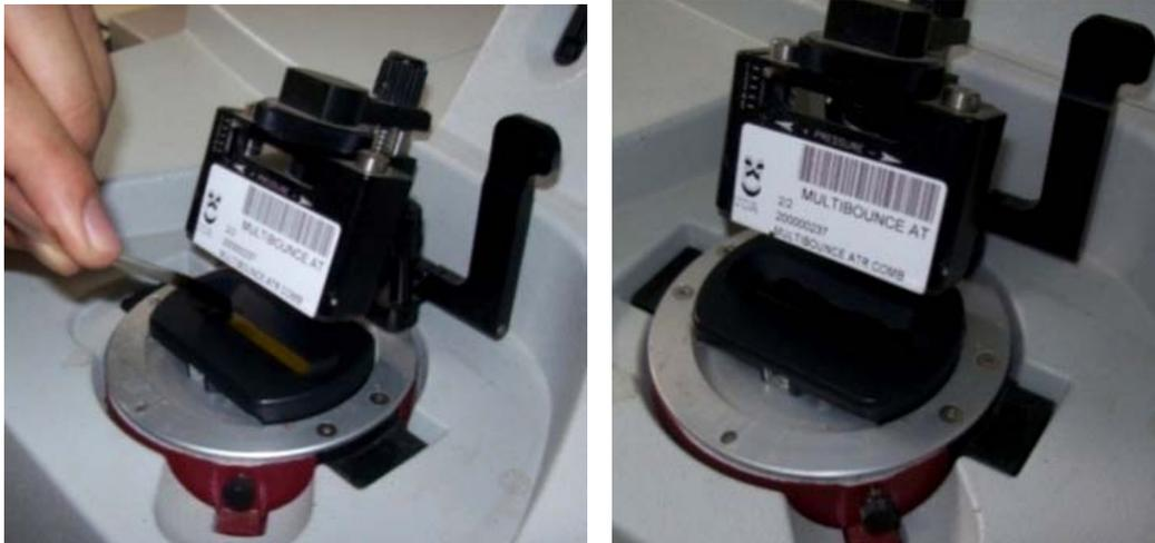
*Fotografía 3.59: Colocación de la placa con la ventana múltiple recubierta de la muestra de aceite.*
