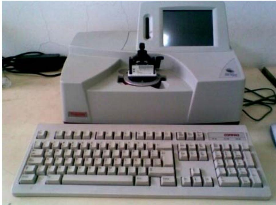
*Fotografía 3.56: Espectrómetro infrarrojo (Foto Autor).*
