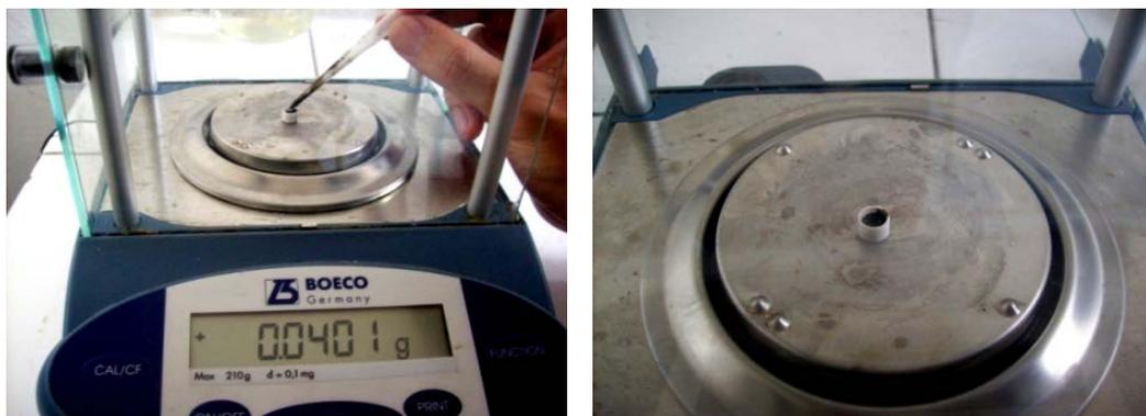
Fotografía 3.66: Colocación de la muestra de aceite en el crisol (Foto Autor).
