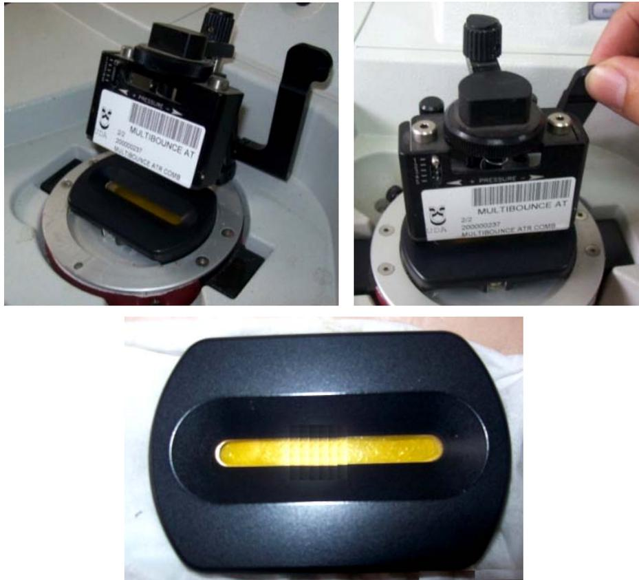
Fotografía 3.58: Colocación de la ventana de refracción múltiple (Foto Autor).
