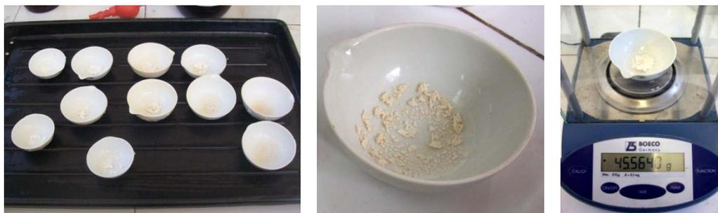
Fotografía 3.12: Pesado de los crisoles con ceniza (Foto Autor).
