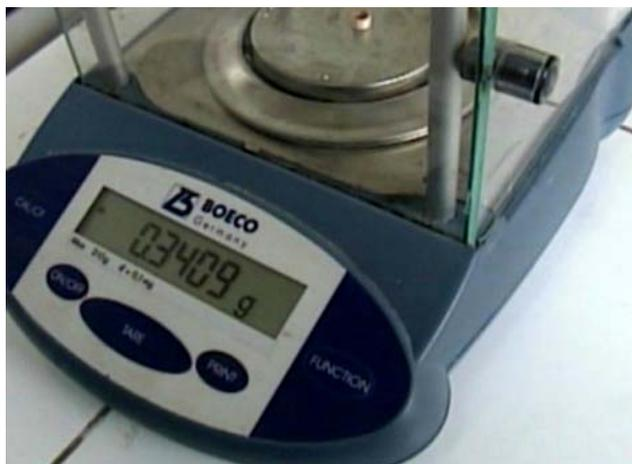
Fotografía 3.67: Pesado del crisol de la termobalanza con la muestra de aceite (Foto Autor).
