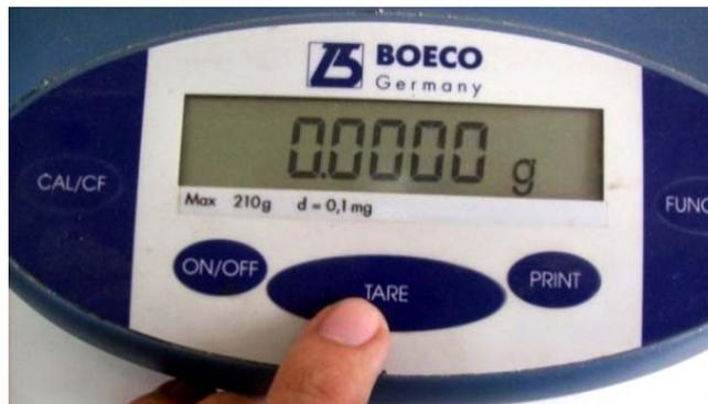
Fotografía 3.65: Encerado de la balanza electrónica (Foto Autor).
