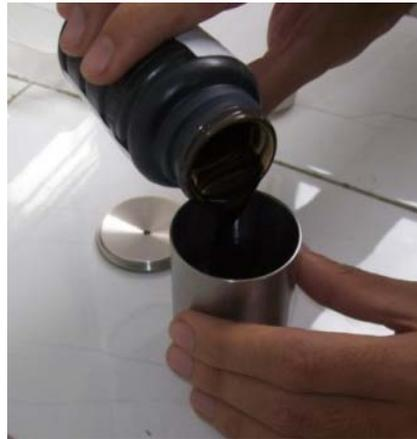
*Fotografía 3.47: Llenado del vaso de medición (Foto Autor).*
