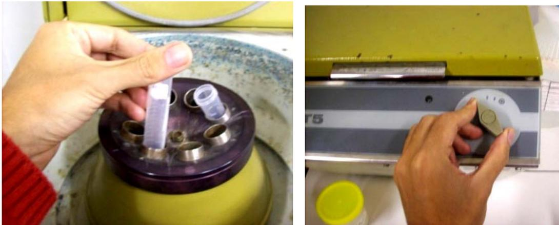
Fotografía 3.38: Centrifugación de las muestras turbias (Foto Autor).
