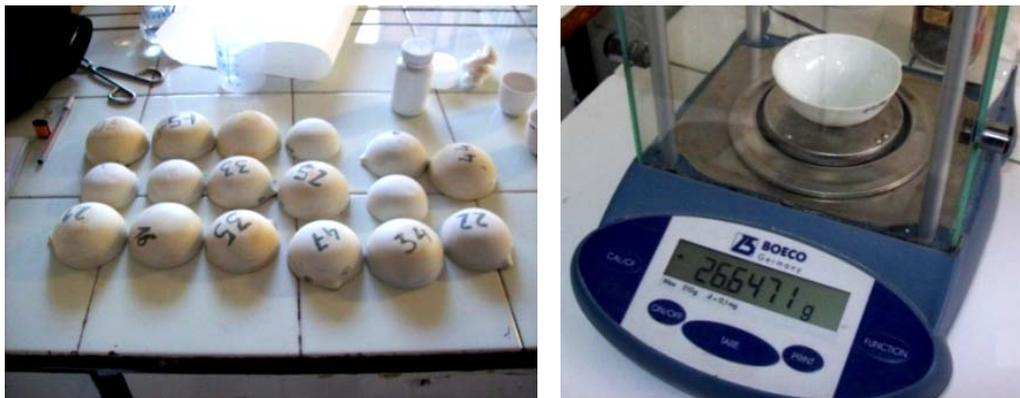
Fotografía 3.2: Crisoles para Quema de muestra y pesado en vacío (Foto Autor).
