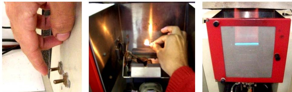
Fotografía 3.25: Encendido del quemador del espectrómetro (Foto Autor).
