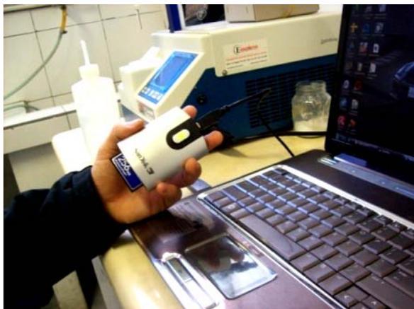
*Fotografía 3.62: Extracción de los datos desde la tarjeta de almacenamiento al computador (Foto Autor).*
