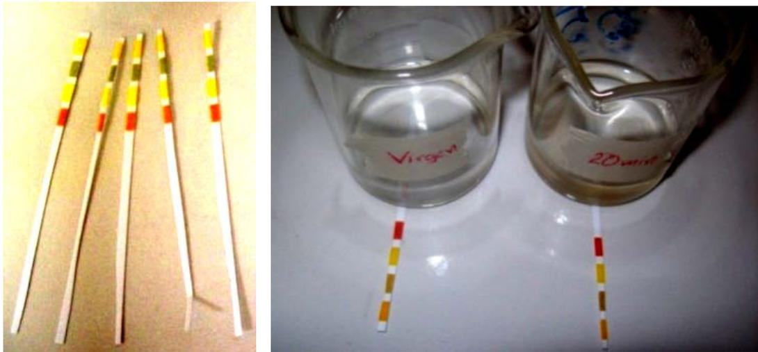
Fotografía 3.36: Medición del PH de las muestras (Foto Autor).
