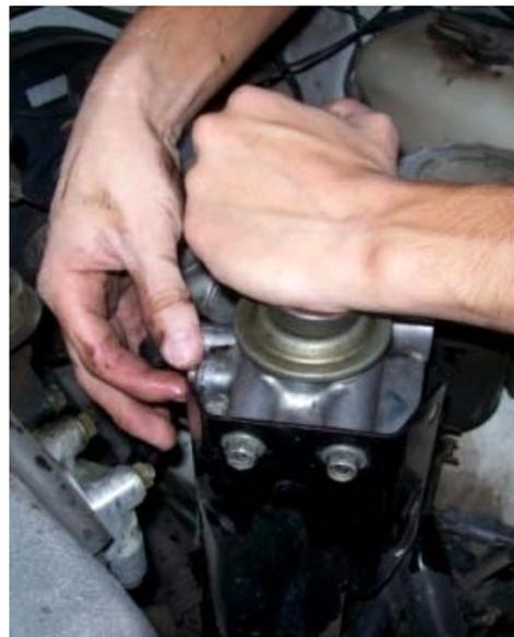
*Fotografía 2.3: Instalación del nuevo filtro de Combustible (Foto Autor).*
