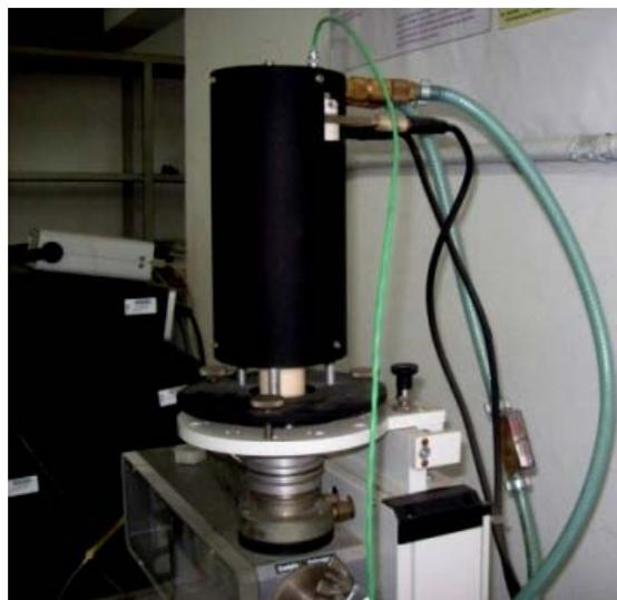
Fotografía 3.77: Revisión del flujo de agua de refrigeración (Foto Autor).
