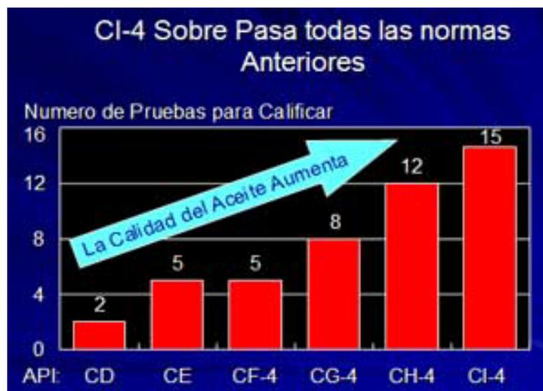
Figura 1.6: Comparación de calidad de la norma CI-4 con sus predecesores. Fuente: Widman international SRL, *El desarrollo de los aceites para motores a diesel*, <mht!http://www.widman.biz/Seleccion/Motores/Desarrollo/desarrollo.html>, Bolivia, 2009
