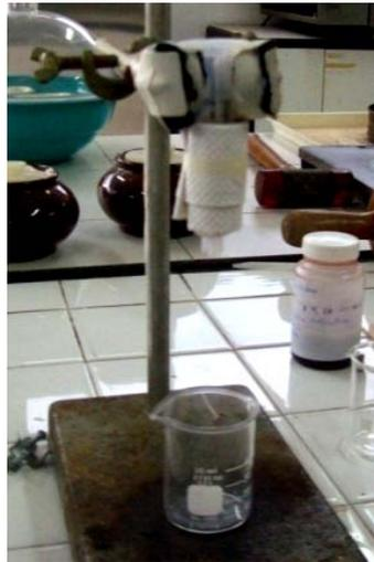
*Fotografía 3.51: Instalación de los implementos para la medición de tiempos de viscosidad (Foto Autor).*
