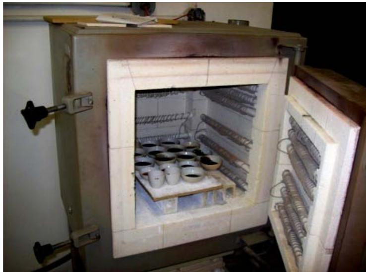
*Fotografía 3.7: Horno Eléctrico utilizado para quema de muestra (Foto Autor).*
