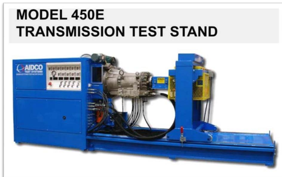
Figura. 2.4: Banco de pruebas 450E para transmisiones automáticas.
