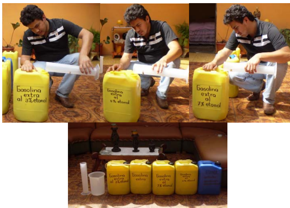
Gráfico10: Elaboración de las mezclas al 3%, 5% y 7% de etanol.
