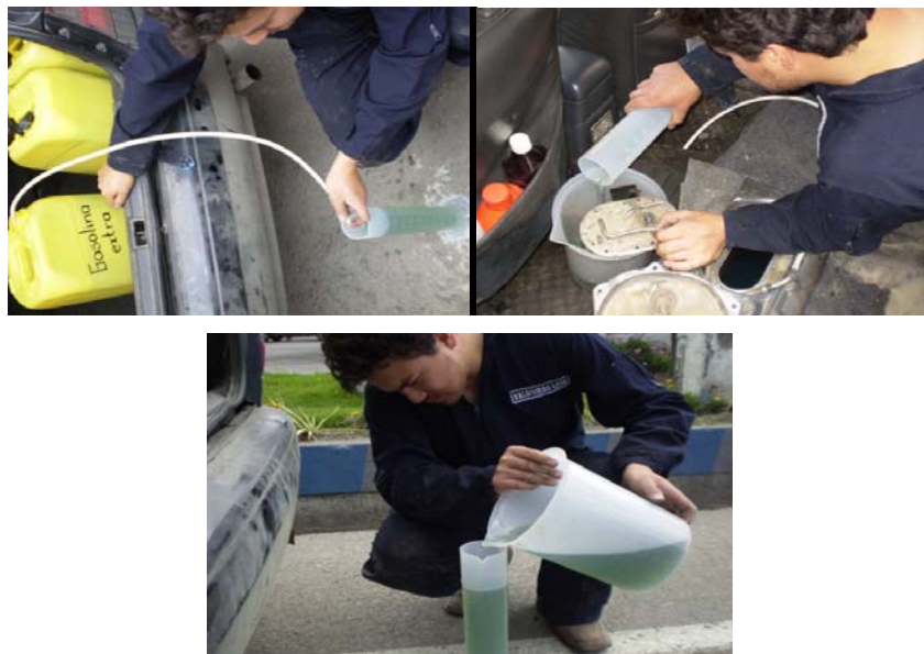
Gráfico16: Secuencia de medición de combustible.
