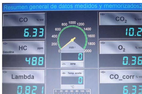
Gráfico 4.7. Prueba estática a 2500 rpm.
