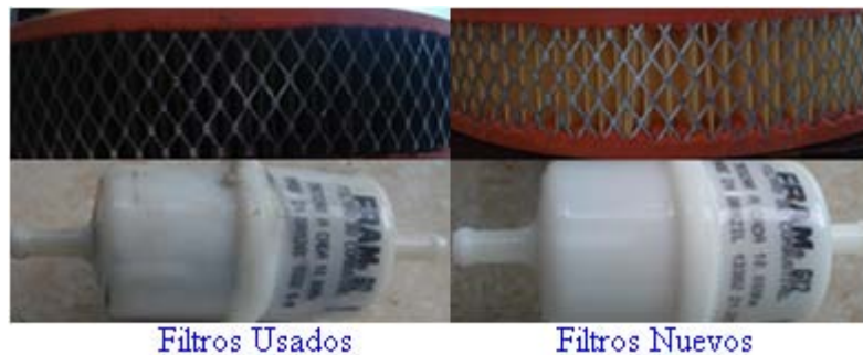
Figura 4.9: Filtros de aire y gasolina.
