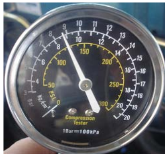
Gráfico: 4.13: Medición en el manómetro de la compresión.
