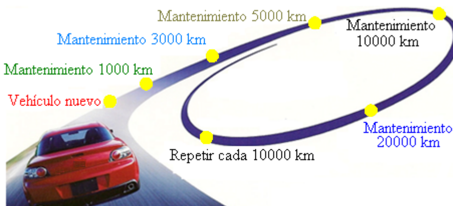
Gráfico 3.2: Intervalos de mantenimiento según el kilometraje.
