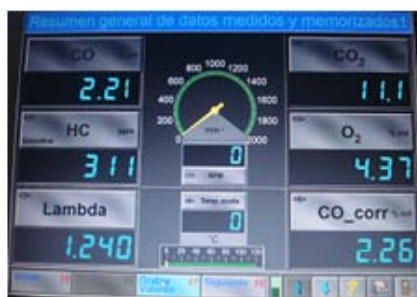
Gráfico 4.14: Prueba estática a ralentí.
