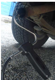
Gráfico 4.4: Sonda metálica sujeta al tubo de escape.
