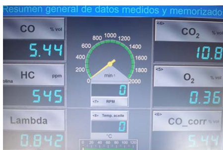
Gráfico 4.6: Prueba estática a ralentí.
