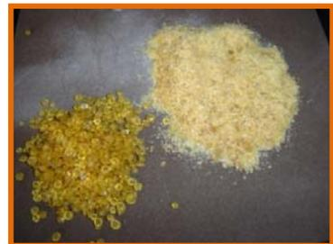
Las colas permiten mantener la estructura original, respetan las características ópticas de la pintura y conservan el índice de refracción original. Sin embargo si no se usa un conservante y fungicida éstas son susceptibles al ataque de microorganismos.
