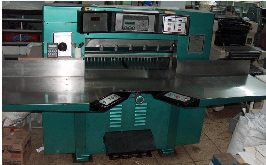
Figura 21.- Guillotina hidráulica Challenge de 95 cm.
