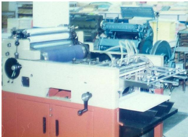
Figura 10.- Máquina offset Multi monocolor
