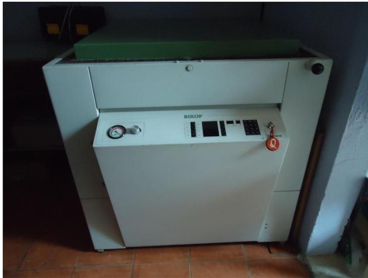
Figura 13.- Insoladora de placas metálicas
