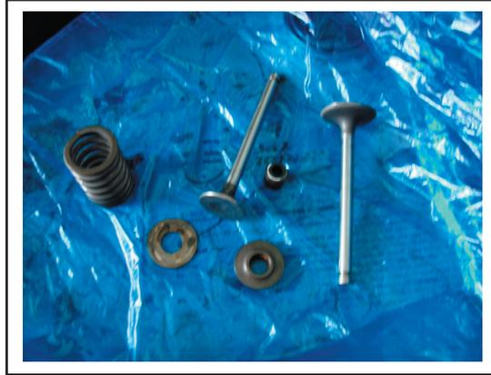
Fig.1.18.- Componentes de la culata
