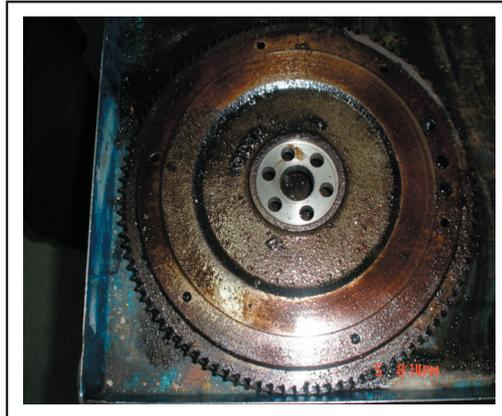
Fig.1.4.-Volante de inercia
