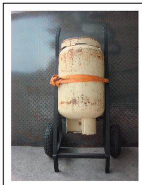
Fig.4.15- Soporte metálico con cilindro de G.L.P.
