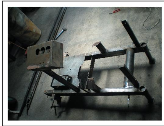
Fig.2.8.- Construcción del banco metálico
