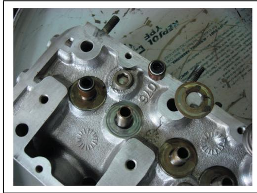
Fig.1.35.- Montaje de juntas de válvulas
