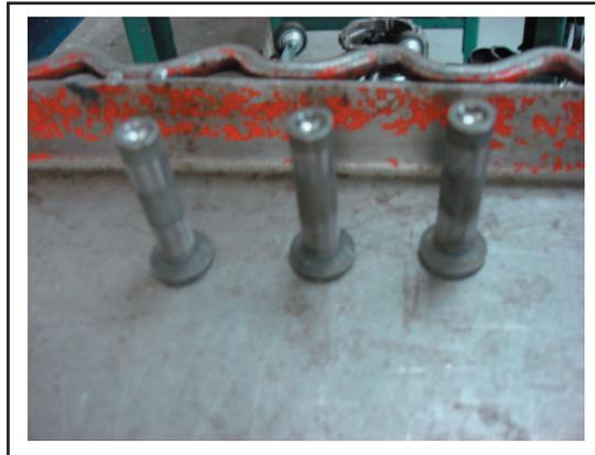
Fig.1.16.- Levantadores de válvulas
