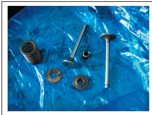
Fig.1.36.- Elementos de armado de las válvulas
