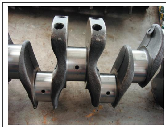
Fig.1.11.- Agujeros de lubricación del cigüeñal
