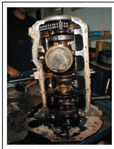
Fig.1.3.- Parte inferior del bloque motor
