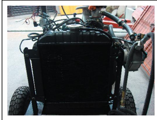
Fig.3.9.- Radiador del motor Nissan 1200 c.c.
