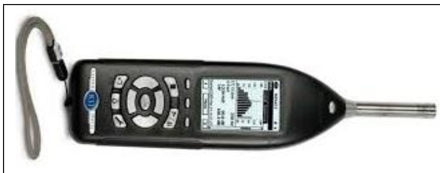
Figura 11 Sonómetro Soudtrack LXT2 - Clase 2
