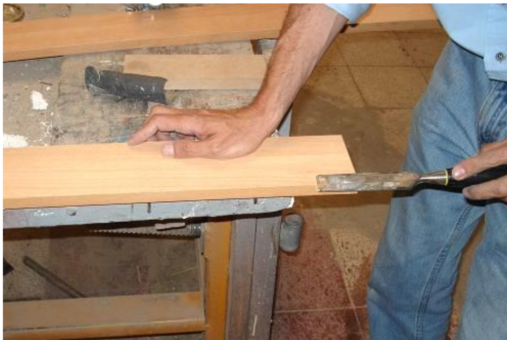
Pulido de cubrecanto y retiro del exceso (Ramiro Serrano 2008)
