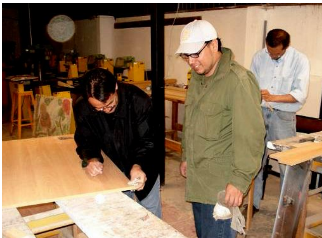
Aplicación del cubrecanto y limpieza (Ramiro Serrano 2008)
