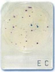
**Es una placa cromogenica lista para usar para la detección de coliformes y e. coli** El medio contiene dos sustratos enzimáticos cromógenos: Magenta-GAL y X-Gluc. De esta manera los coliformes desarrollan una coloración roja, mientras que la de los *E.coli* es azul.
